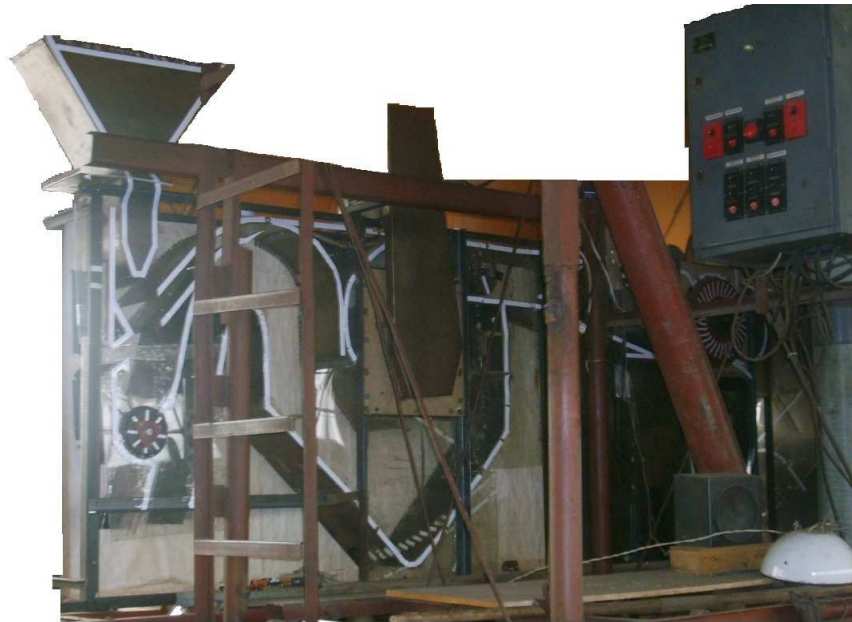
Рисунок 5 - Общий вид экспериментальной установки для исследования малогабаритной пневмосистемы машины предварительной очистки зерна (ширина проточной части B=0,3 м)
