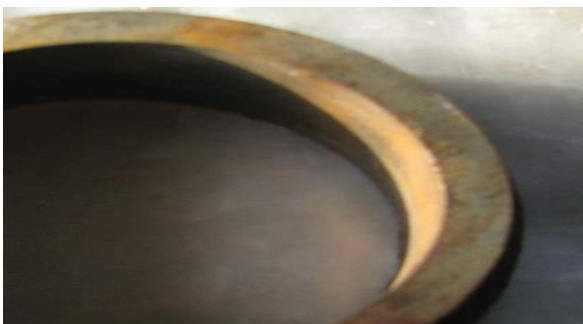
Рисунок 8 – Шибера и седло запорно-регулирующей задвижки по истечении 18 месяцев работы
