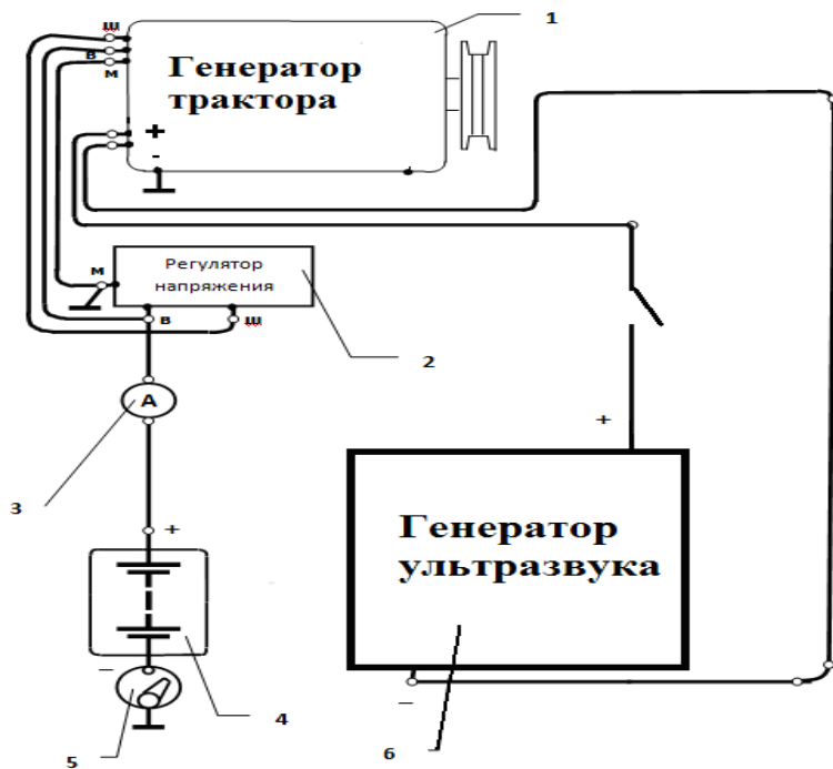
Рис. 4. Электрическая схема подключения ультразвукового прибора на тракторе: 1 – генератор переменного тока Г-306Б1; 2 – регулятор напряжения РР-362Б; 3 – амперметр; 4 – аккумуляторная батарея; 5 – включатель «массы»; 6 – ультразвуковой прибор
