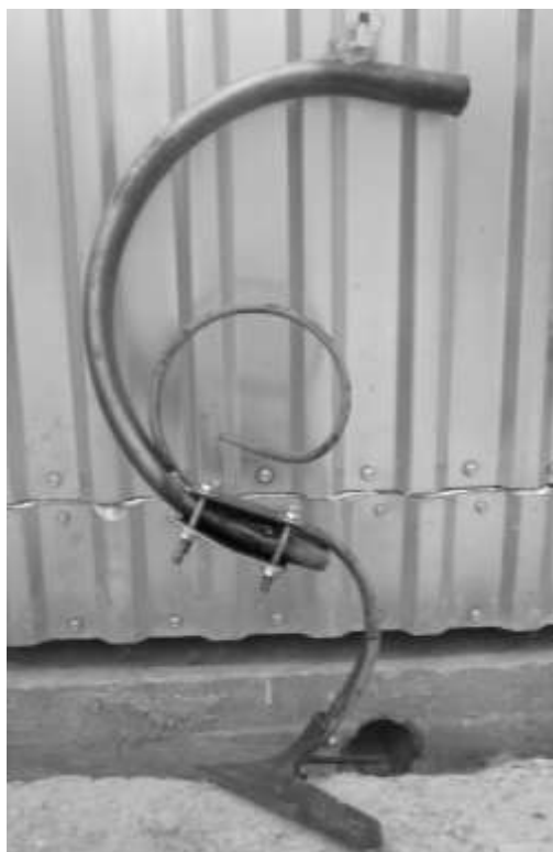
а – Образец с Г.Т.Э. сталь 10$ б – Образец с Г.Т.Э. сталь 12X18H10T Рисунок 10 – Образцы для полевых испытаний
