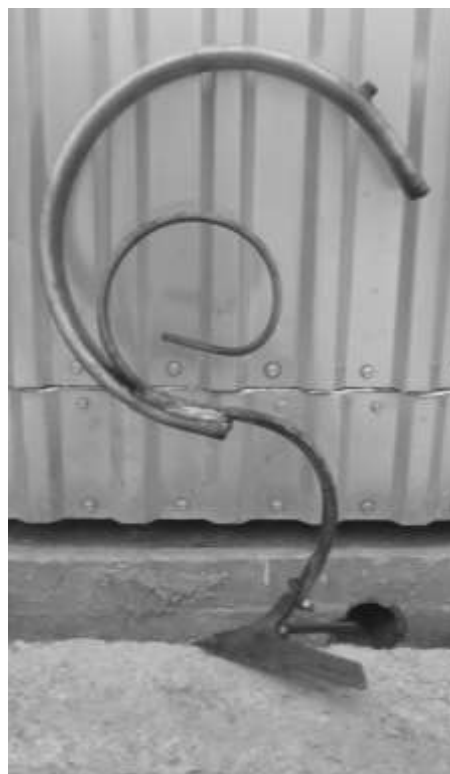
а – Образец с Г.Т.Э. сталь 10$ б – Образец с Г.Т.Э. сталь 12X18H10T Рисунок 10 – Образцы для полевых испытаний
