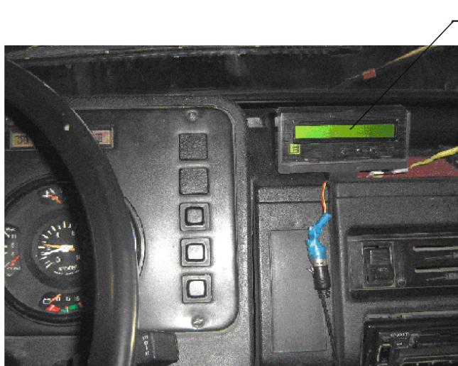
Рисунок 7 – Установка устройства для мониторинга буксования ведущих колес в кабине автомобиля ЗиЛ-433360: 1 – корпус электронного блока управления устройства для мониторинга буксования
