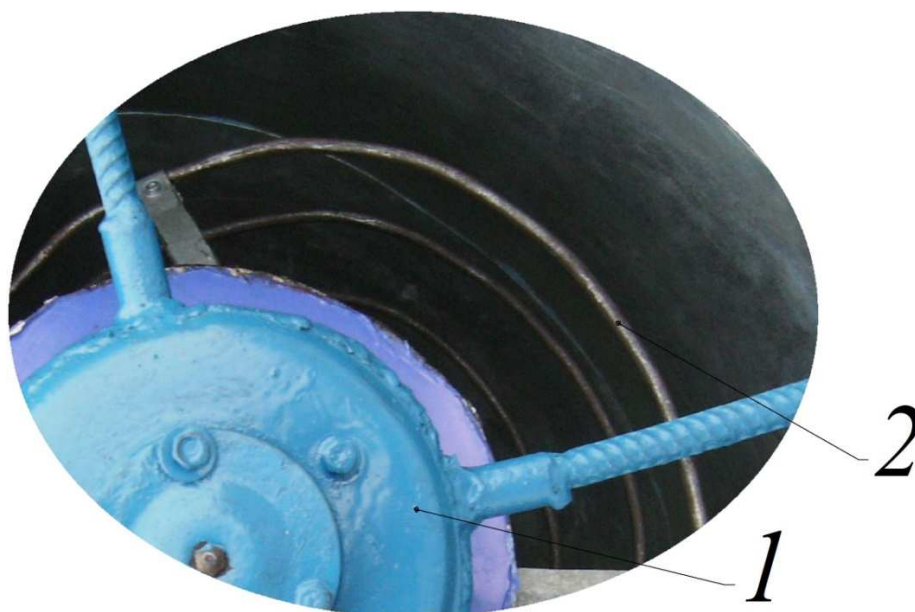
Рисунок 8 – Лабораторный смеситель кормов (вид сверху при открытой крышке):
