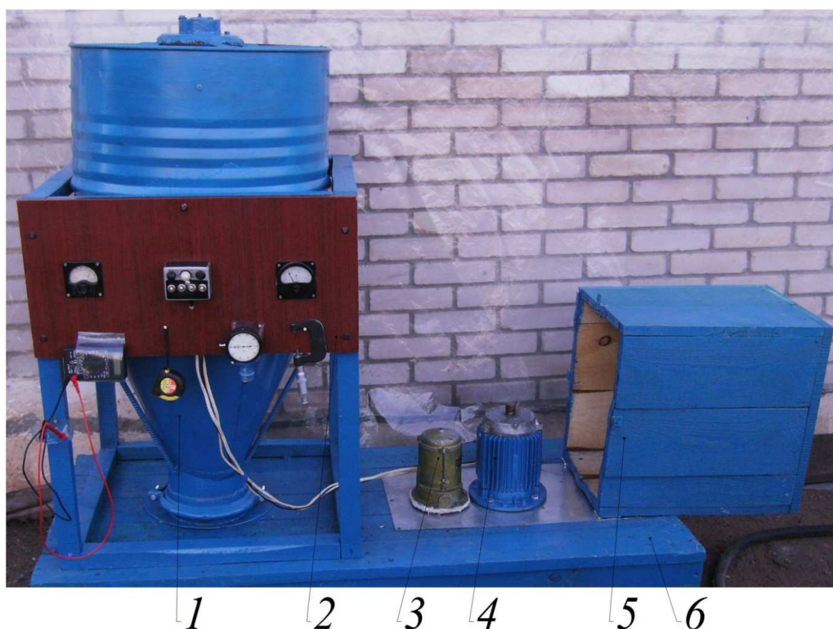
Рисунок 7 – Лабораторная установка: 1 – смеситель; 2 – панель приборов; 3 – редуктор; 4 – электродвигатель; 5 – откидной защитный кожух; 6 – платформа
