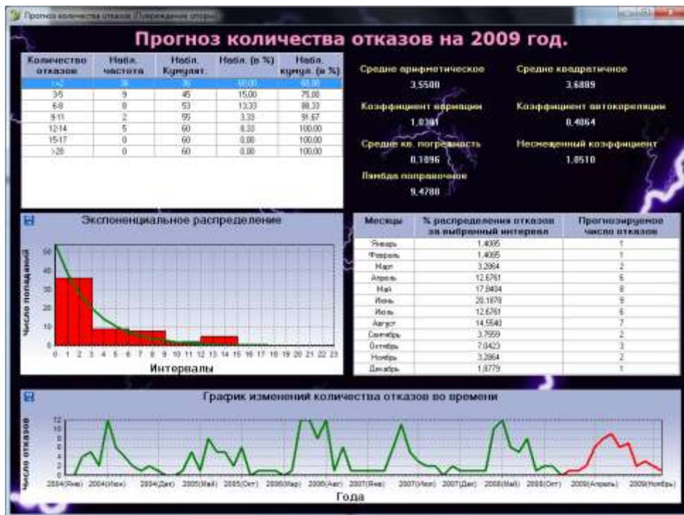
Рисунок 8 – Окно вывода результатов прогнозирования для причины «Повреждение опор» с учётом автокорреляции значений выборки
