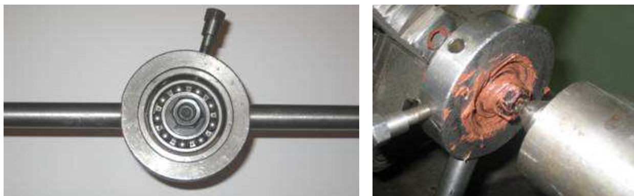
Рисунок 3 – Специальное приспособление и проведение стендовых испытаний подшипников качения на токарно-винторезном станке
