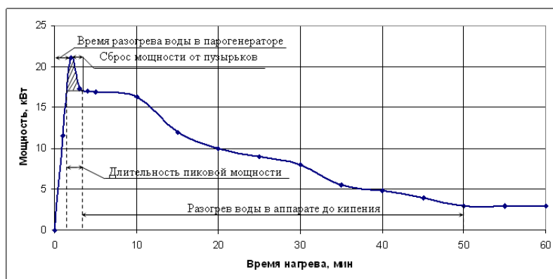
Рисунок 9 – Динамика потребляемого теплового потока аппаратом V_{60} ( V_{60} – аппарат, ёмкостью 60 л).
