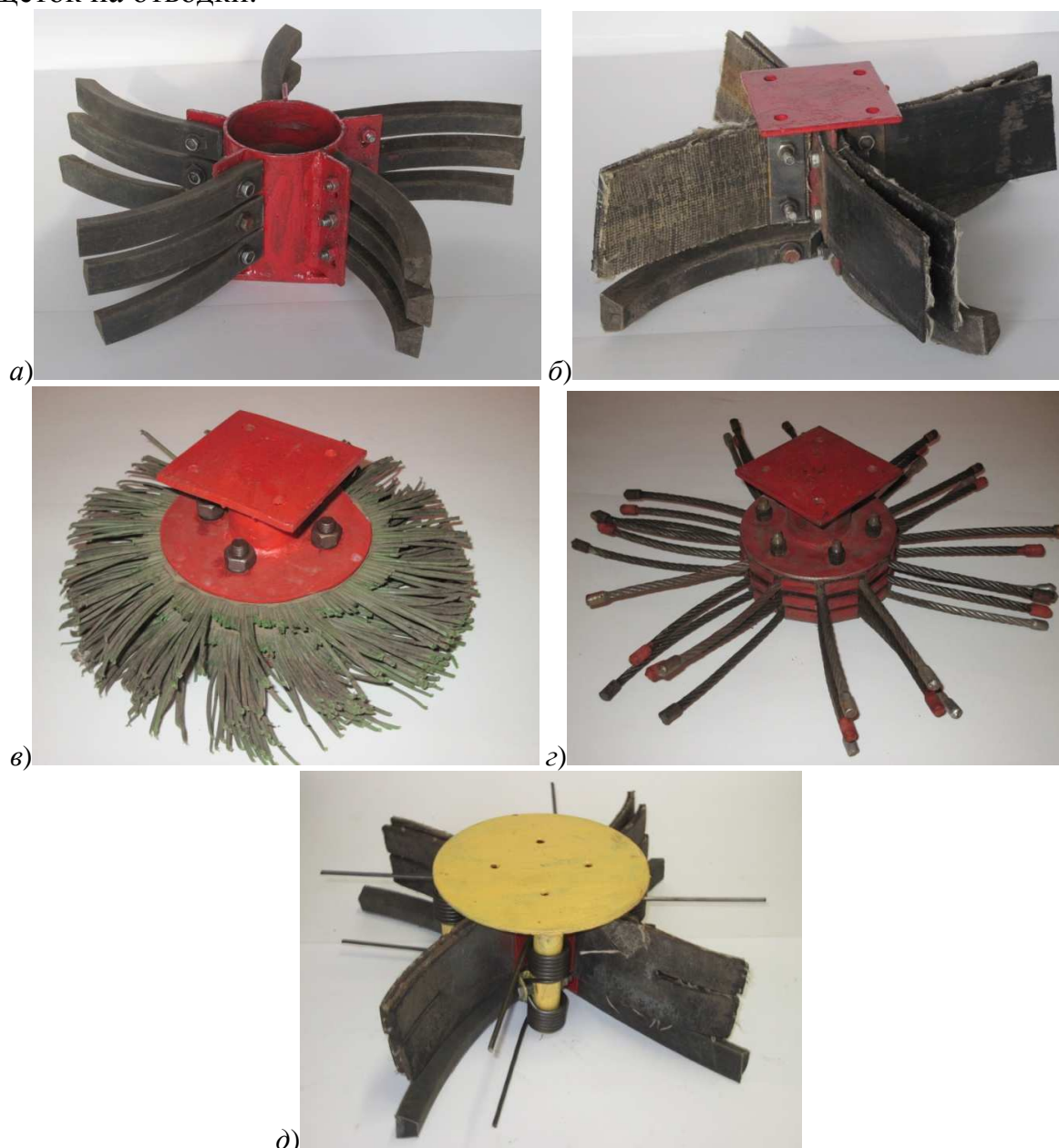
Рисунок 11 – Ротационные рабочие органы с лопастями различной жесткости
