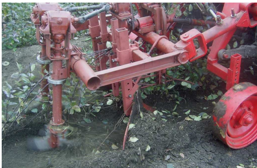
Рисунок 15 – Опытный образец машины для раскрытия корневой системы вегетативно размножаемых подвоев в работе
