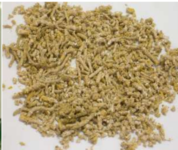
Рисунок 14 – Измельченная пшеница влажностью 21,8 %
