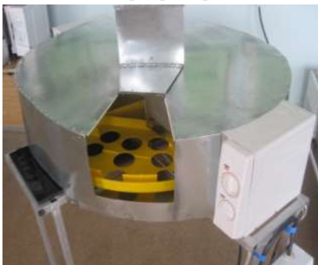
Рисунок 8 – Реальное исполнение СВЧ-индукционной установки с запредельным диафрагмированным волноводом
