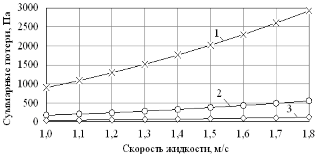
Рисунок 10 – Зависимости суммарных сопротивлений движению обмывочной жидкости от её скорости при диаметре шланга: 1 – 10 мм; 2 – 15 мм; 3 – 20 мм
