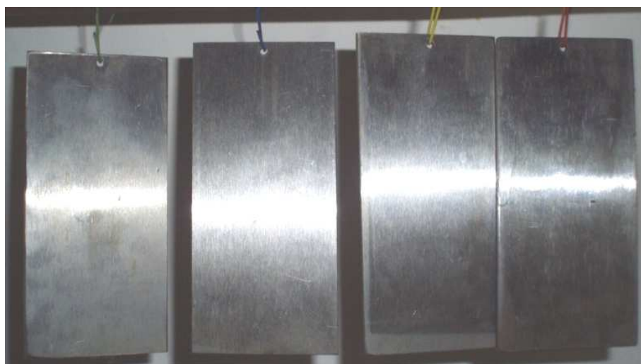
Рисунок 10 – Внешний вид образцов после 12-ти месячных натурно-стендовых испытаний в закрытом неотапливаемом помещении.
