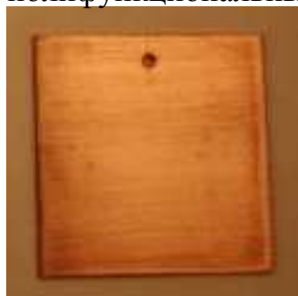
Рисунок 3 – Результаты испытания медных пластин в водном растворе бензотриазола.
