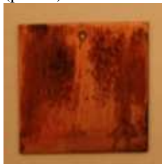
Рисунок 2 – Образование комплексных соединений на поверхности медных пластин после погружения их в раствор этаноламинов.
