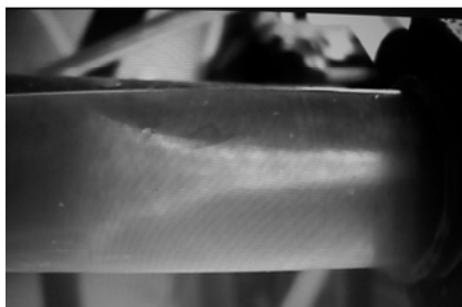
Рисунок 7 - Вращение газовой воронки при закрытой дроссельной заслонке (воронка выходит из центра области соплового входа)
