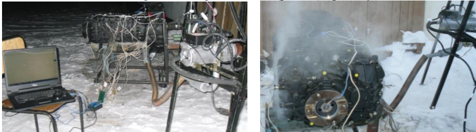
Рисунок 13 Экспериментальная установка для исследования возможности использования отработавших газов подогревателя для разогрева масла в КП
