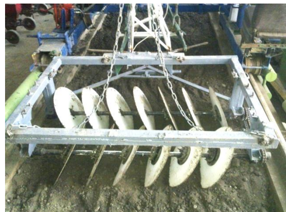
Рисунок 3 – Схема ( а ) и общий вид ( б ) экспериментальной дисковой бороны
