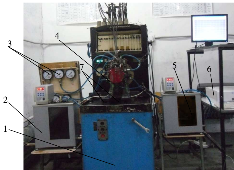
Рисунок 3 – Общий вид экспериментальной установки для ускоренных испытаний плунжерных пар ТНВД на износ: 1 – стенд КИ-921М; 2 – бак для ДСТ (термостат ТЖ-ТС-01НМ); 3 – манометры; 4 – модернизированный насос для сравнительных испытаний плунжерных пар; 5 – бак для ДТ (термостат ТЖ-ТС-01НМ); 6 – компьютер с АЦП LA-1,5 PCI; 7 – мультиметры
