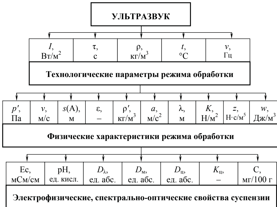
Рисунок 2 – Влияние технологических параметров режима УЗ-обработки на физические характеристики процесса и свойства суспензии
