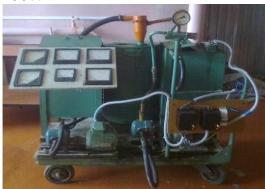
Рисунок 6 – Лабораторная установка для очистки отработанных трансмиссионных масел
