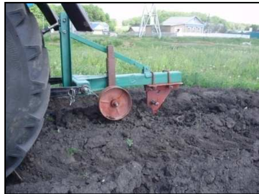
1-долото; 2-стойка; 3-колесо; 4-винт; 5-нож; 6-навеска.
