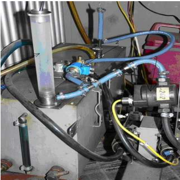
1 – электронная мензурка; 2 – электромагнитный клапан; 3 – роliko-лопастной расходомер Рисунок 1 – Устройство измерения цикловой подачи топлива
