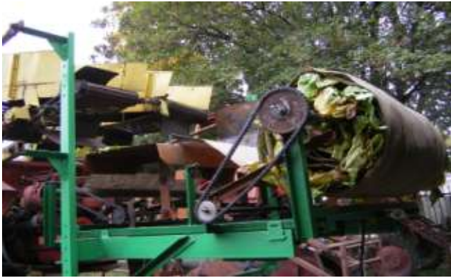
Рисунок 11 - Испытание устройства для накопления листьев в рулоне
