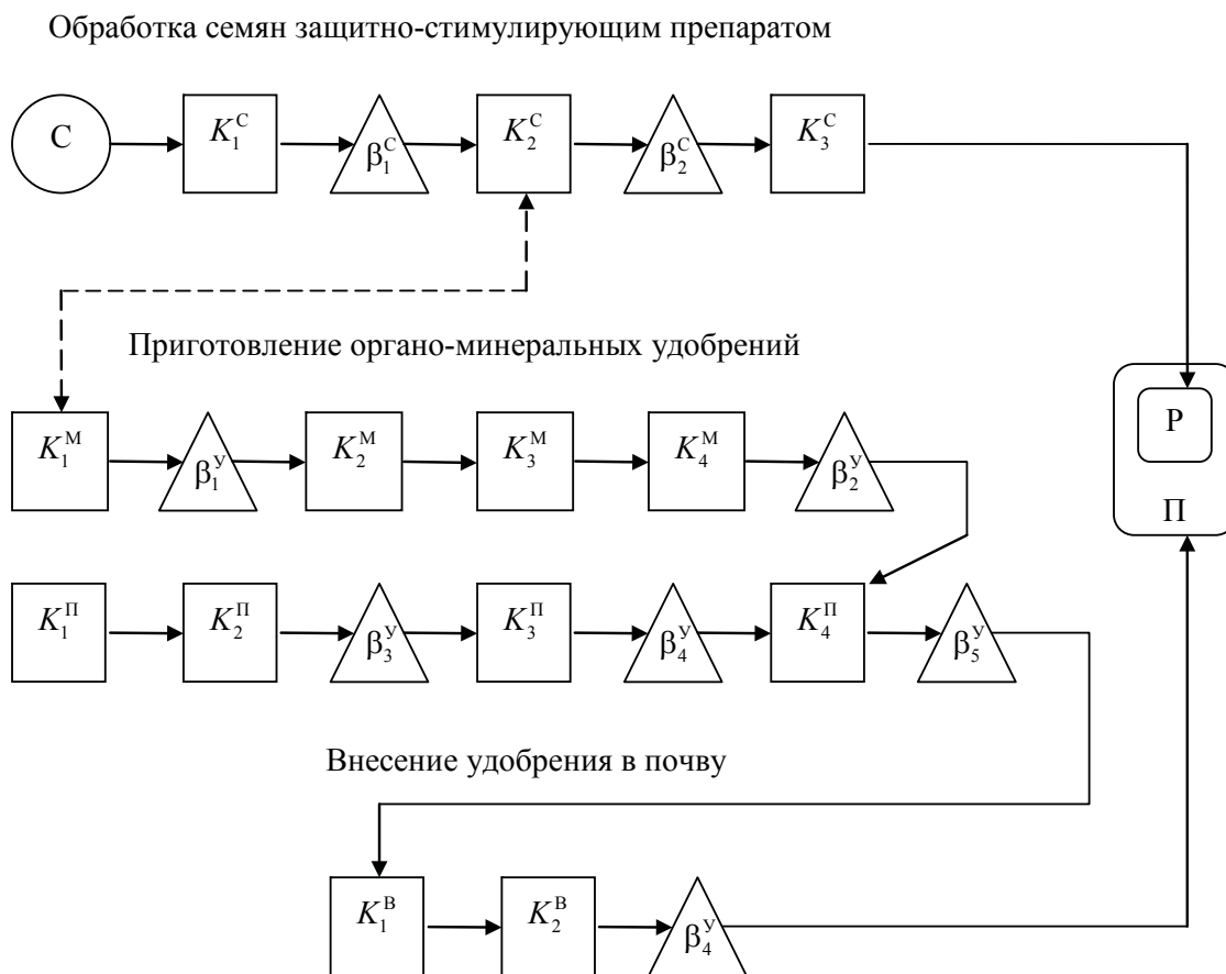
Рисунок 1 – Операторная схема комплексного ресурсосберегающего технологического процесса предпосевной обработки почвы и семян при возделывании сельскохозяйственных культур:
