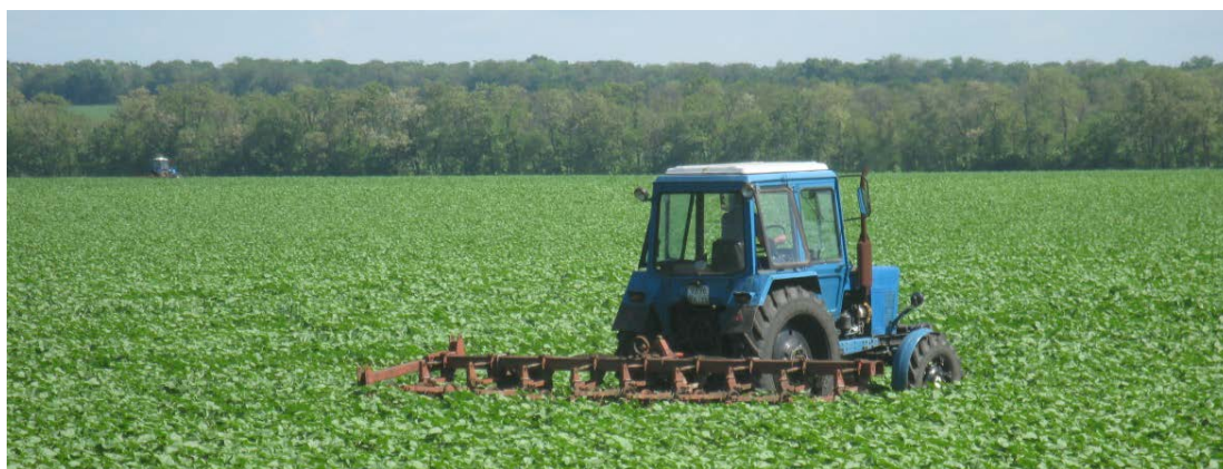
Рисунок 3 – Междурядная культивация подсолнечника агрегатом МТЗ-82+КРН-5,6
