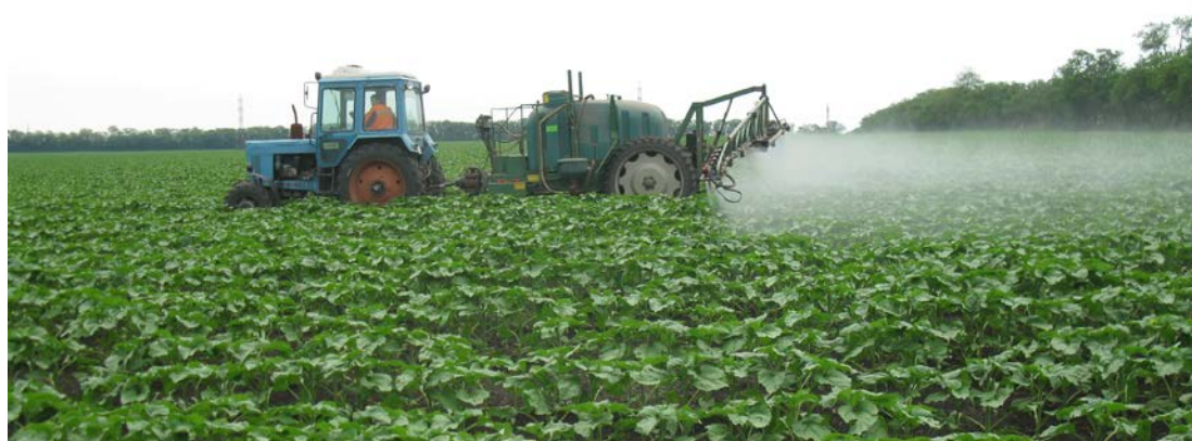
Рисунок 4 – Вторая листовая обработка подсолнечника агрегатом МТЗ-82+ОПГ-3000 «Гварта 5»
