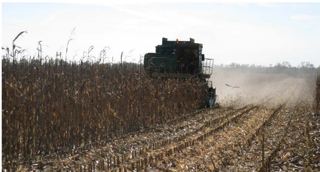
Рисунок 15 – Уборка кукурузы на зерно комбайном Дон 1500Б
