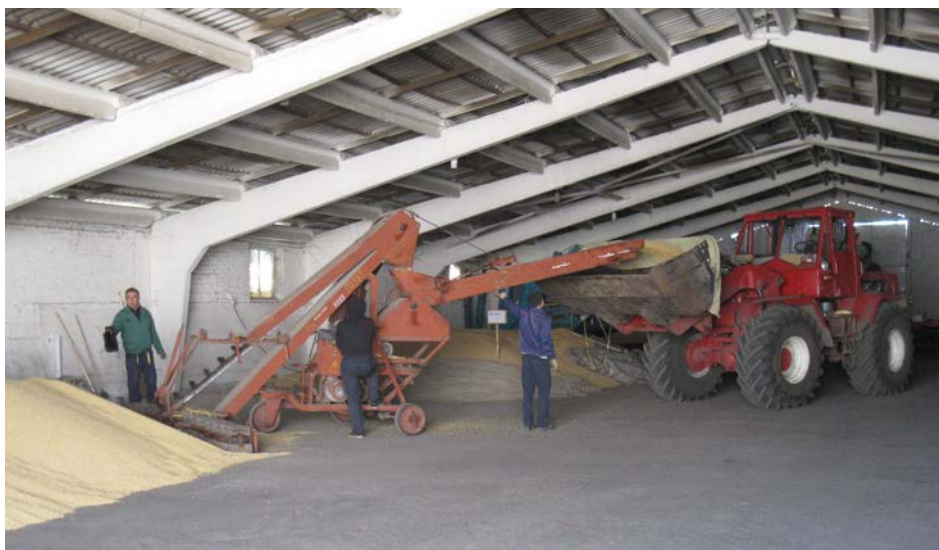
Рисунок 1 – Предпосевная обработка семян в складе ПС-20К-4
