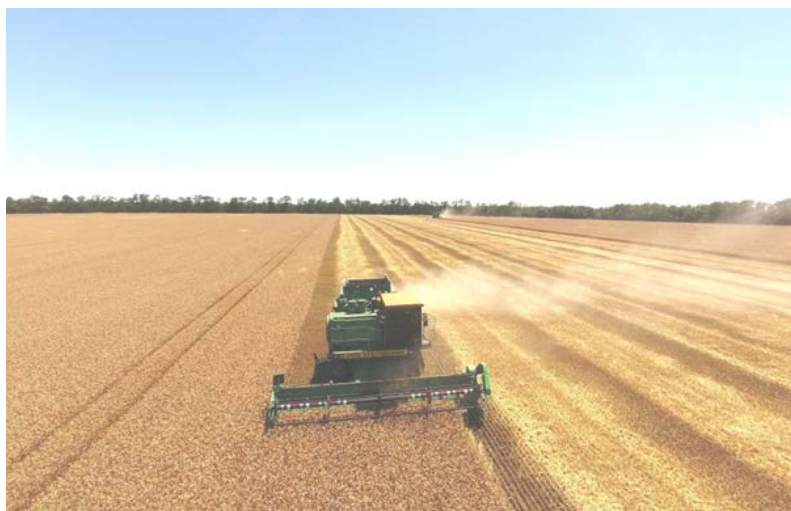
Рисунок 2 – Работа комбайнов Дон-1500Б в новом варианте челночным способом
