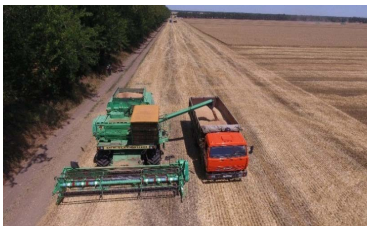
Рисунок 5 – Выгрузка зерна в новом варианте работы на краю поля в автомобиль КАМАЗ-5320
