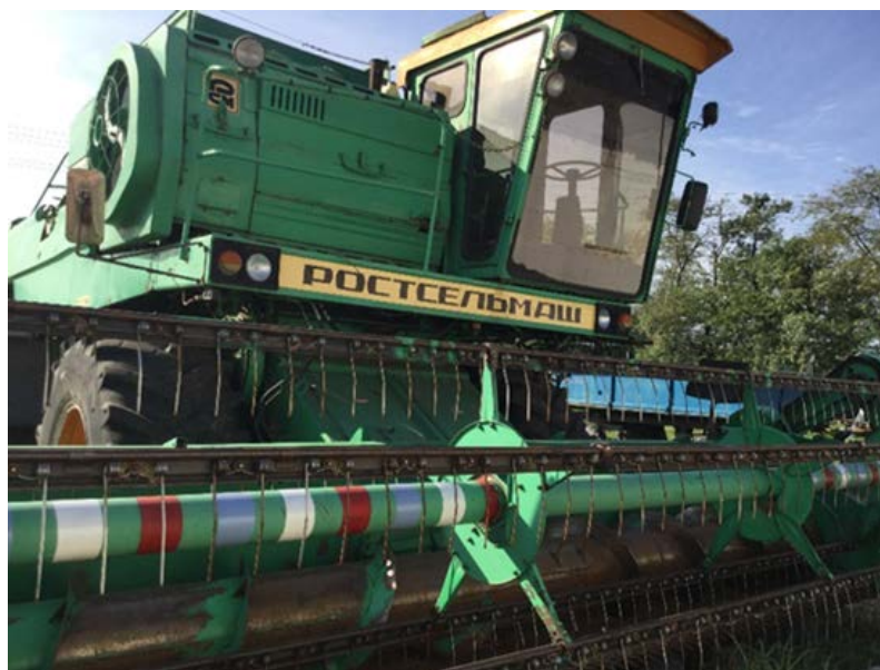
Рисунок 1 – Разметка вала мотовила комбайна Дон-1500Б
