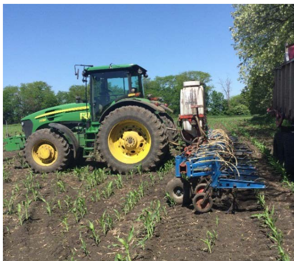
Рисунок 21 – Пропашной культиватор SKM в агрегате с трактором John Deere 7730 на культивации кукурузы с одновременным внесением КАС-32
