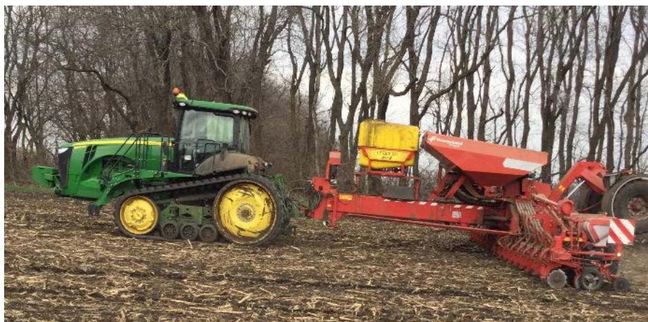
Рисунок 5 – Общий вид сеялки точного высева Optima TFmaxi в агрегате с трактором John Deere 8310RT
