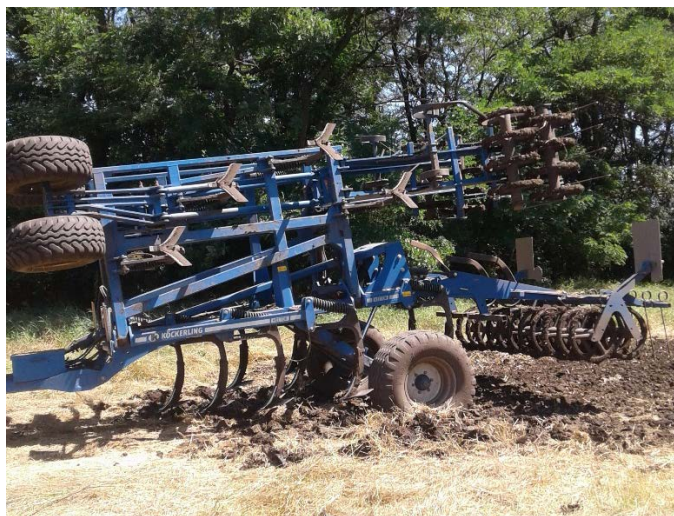
Рисунок 17 – Культиватор Vector 460 в варианте оснащения рабочих органов боковыми крыльями
