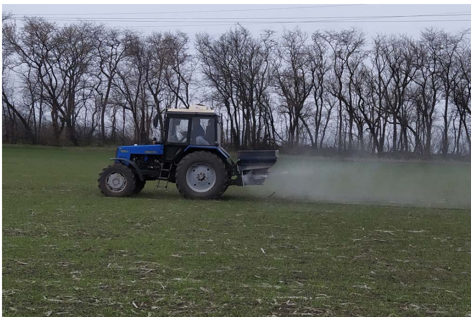
Рисунок 4 – Общий вид разбрасывателя минеральных удобрений Bogballe M2 в агрегате с трактором Беларус 1025.2 на подкормке озимой пшеницы
