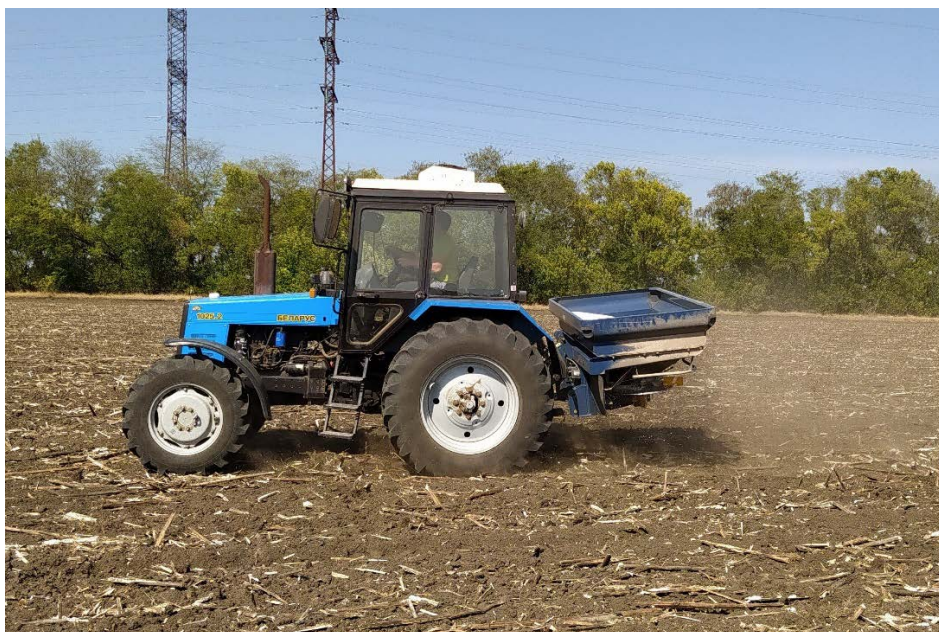
Рисунок 2 – Дифференцированное внесение основной дозы минеральных удобрений под посев озимой пшеницы агрегатом Беларус 1025.2+Vogballe M2
