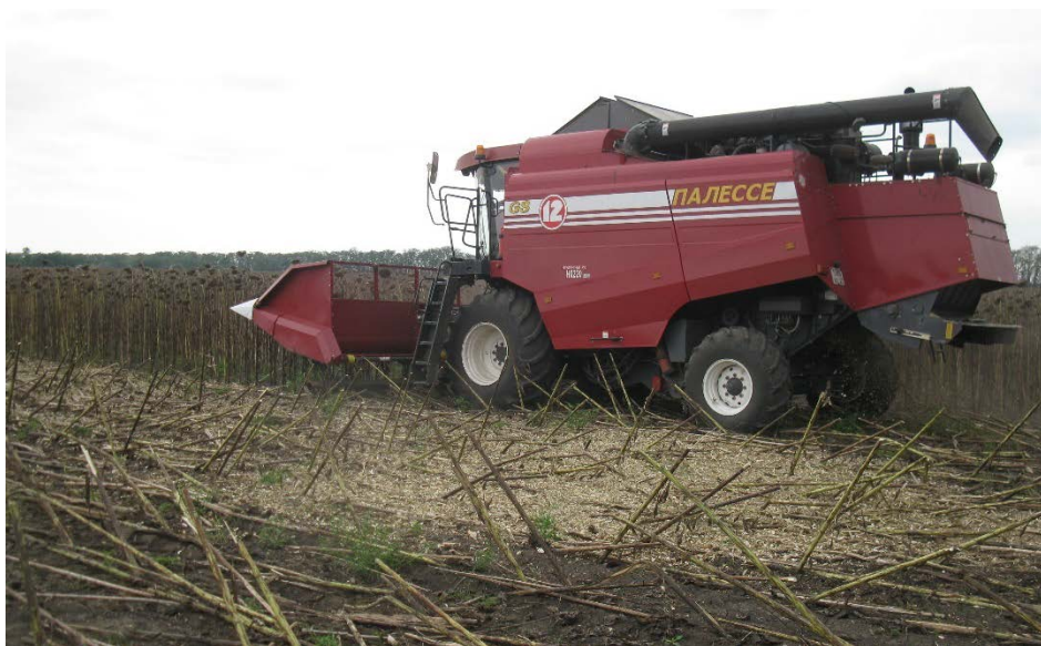
Рисунок 1 – Зерноуборочный комбайн Полесье GS-12, оборудованный системой картирования урожайности Trimble YM на уборке подсолнечника
