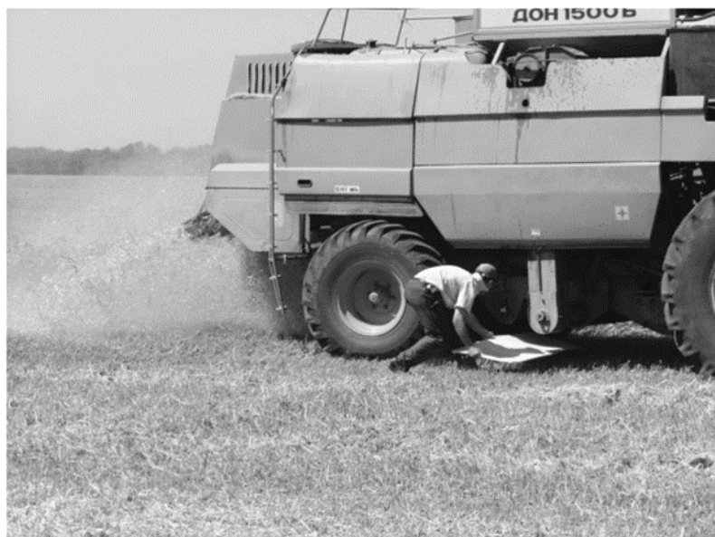
Рисунок 1 – Процесс установки побоотборника под комбайн
