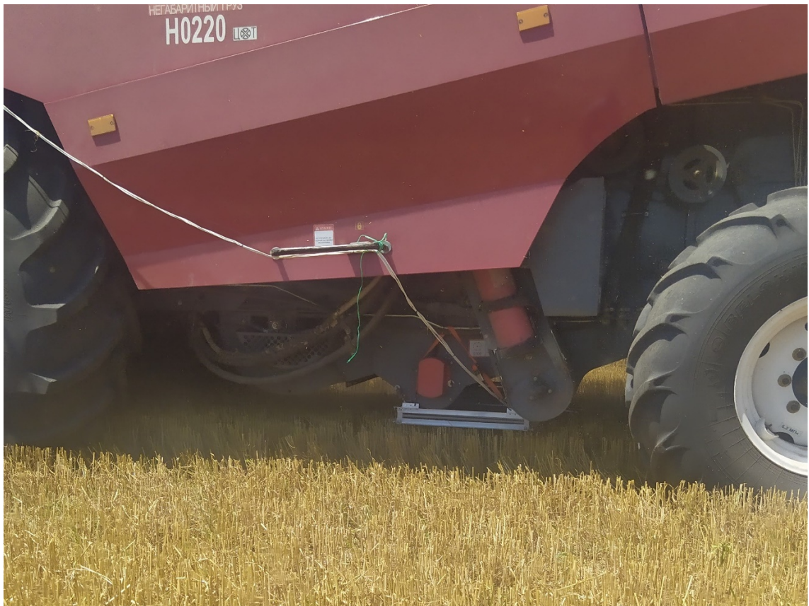
Рисунок 9 – Общий вид смонтированного на комбайне расстановщика пробоотборников
