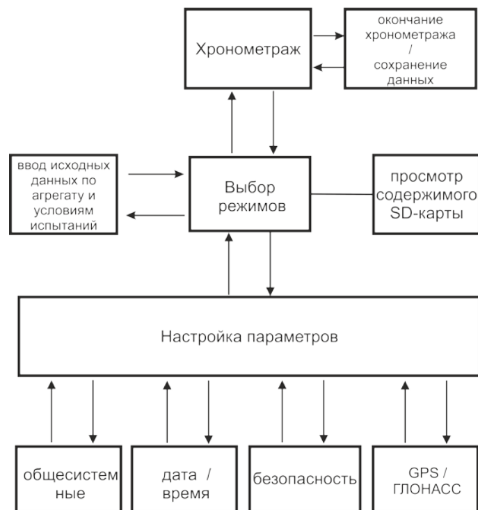
Рисунок 8 – Блок-схема программного обеспечения универсального хронометра
