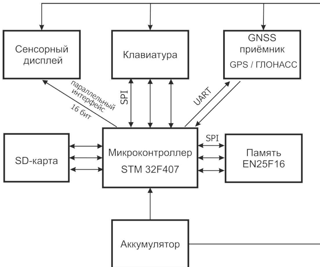
Рисунок 3 – Структурная схема универсального хронометра
