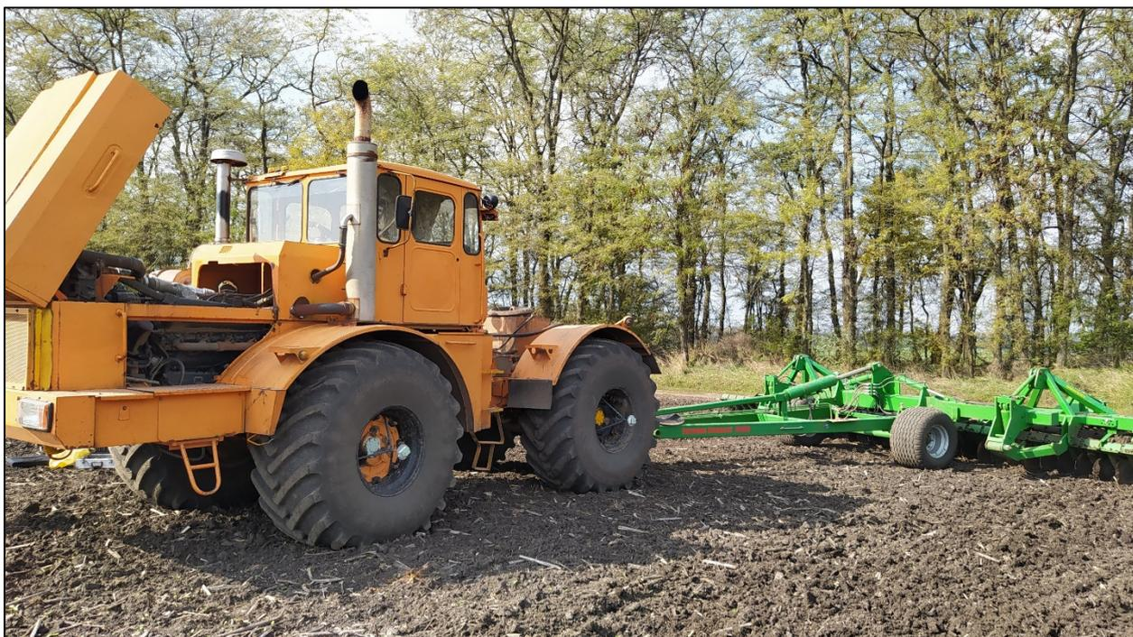
Рисунок 18 – Подготовка агрегата К-700А+КДК-9 для проведения полевого эксперимента
