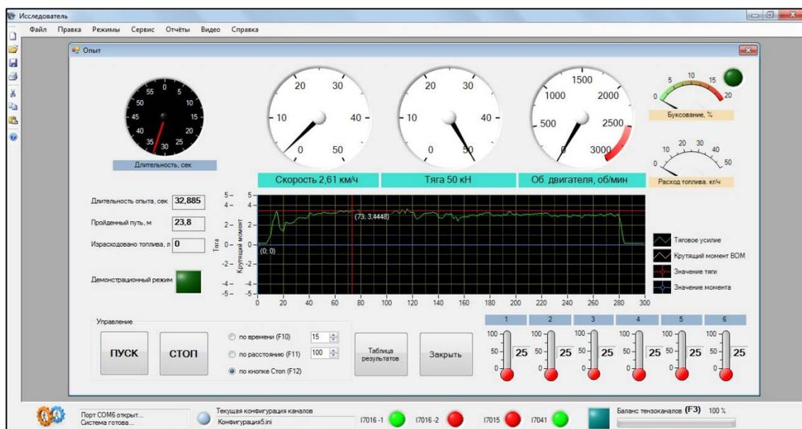
Рисунок 16 – Окно проведения опыта при измерении тягового сопротивления
