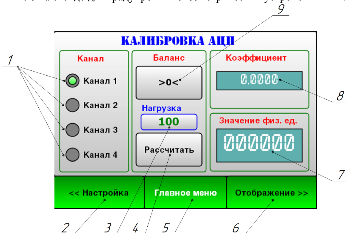
Рисунок А.11 – Калибровка тензодатчика измерителя твердости почвы ИП-298 на стенде для градуировки тензометрических устройств ИП-272
