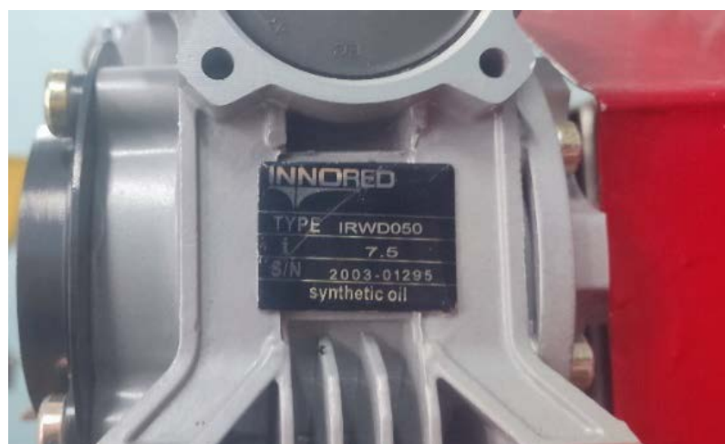
Рисунок 7 – Общий вид редуктора с обозначением параметра передаточного числа
