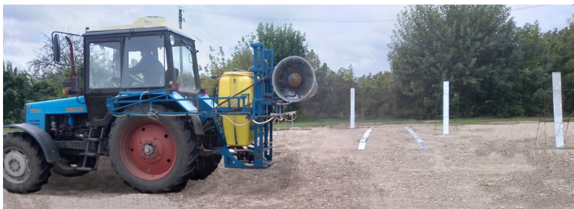
Рисунок 4 – Нанесение капель на карточки из воздушно-капельного потока, создаваемого подачей факелов распыла щелевыми распылителями в воздушный поток начального участка струи
