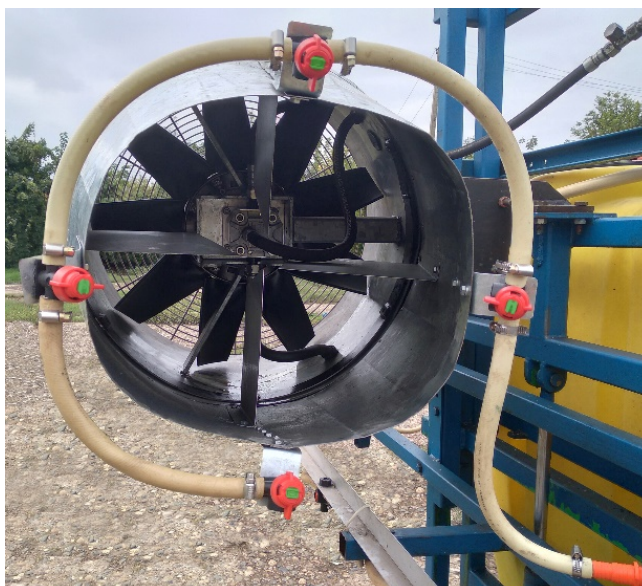
Рисунок 18 – Техническое средство для краевой обработки поля (вид спереди) с применением четырех щелевых распылителей LU-015. AD-015 (код цвета – зеленый)
