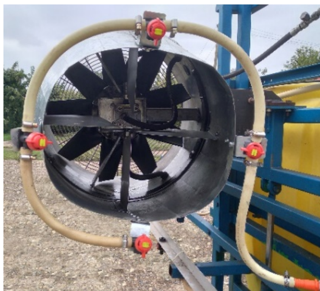
Рисунок 17 – Техническое средство для краевой обработки поля (вид спереди) с установленными четырьмя щелевыми распылителями LU-02. AD-02 (код цвета – желтый)
