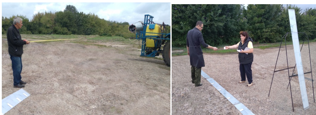
а) измерение расстояний рулеткой от сопла до начала расположения планшетов и расстановка карточек
