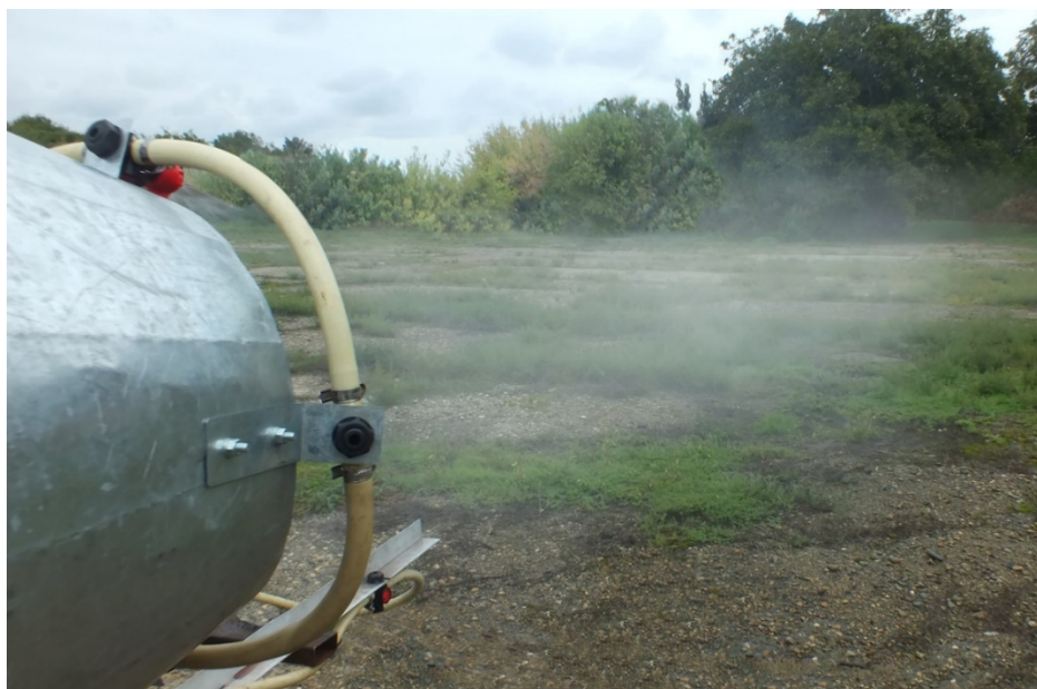
Рисунок 8 – Процесс инжектирования капель факелов распыла жидкости щелевых распылителей воздушным потоком струи и их транспортирование в форме воздушно-дисперсной системы
