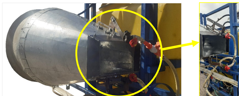
Рисунок 1 – Общий вид технического средства с плоским наконечником и установленными на нем двумя щелевыми распылителями
