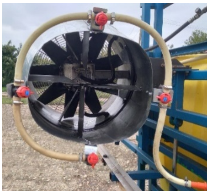
Рисунок 15 – Техническое средство для краевой обработки поля (вид спереди) с крестообразно установленными двумя щелевыми распылителями LU-04. AD-04 (код цвета – красный) и двумя щелевыми распылителями LU-03. AD-03 (код цвета –синий)
