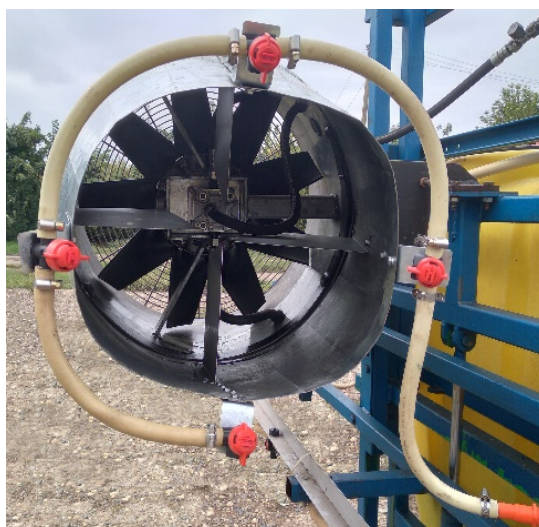
Рисунок 12 – Техническое средство для краевой обработки поля (вид спереди) с установленными на образующей сопла четырьмя щелевыми распылителями LU-04. AD-04 (код цвета – красный)
