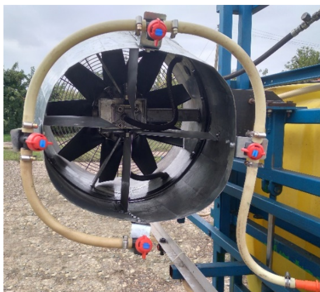
Рисунок 16 – Техническое средство для краевой обработки поля (вид спереди) с установленными четырьмя щелевыми распылителями LU-03. AD-03 (код цвета – синий)
