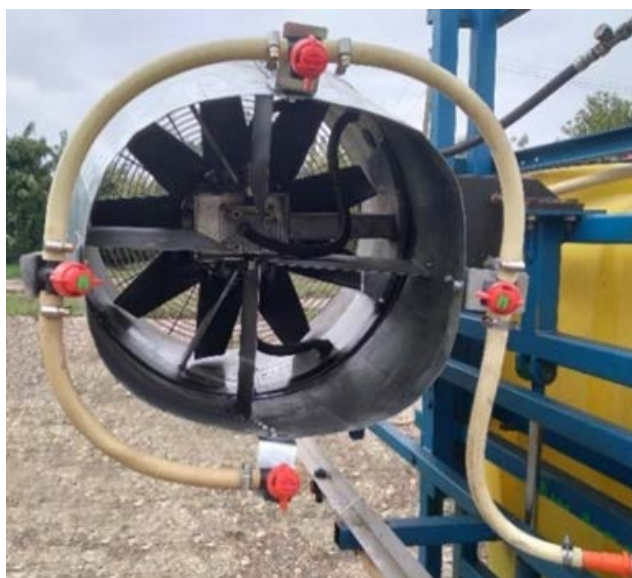
Рисунок 13 – Техническое средство для краевой обработки поля (вид спереди) с установленными двумя щелевыми распылителями LU-04. AD-04, (код цвета – красный) в вертикальном направлении и двумя щелевыми распылителями LU-015. AD-015, (код цвета –зеленый) в горизонтальном направлении
