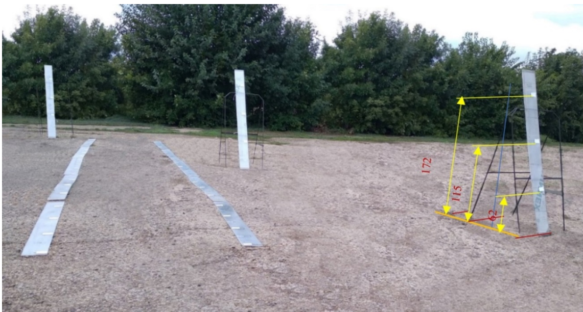
Рисунок 3 – Расстановка планшетов по отношению к краю конического сопла технического средства на расстояниях 5, 10 и 15 м
