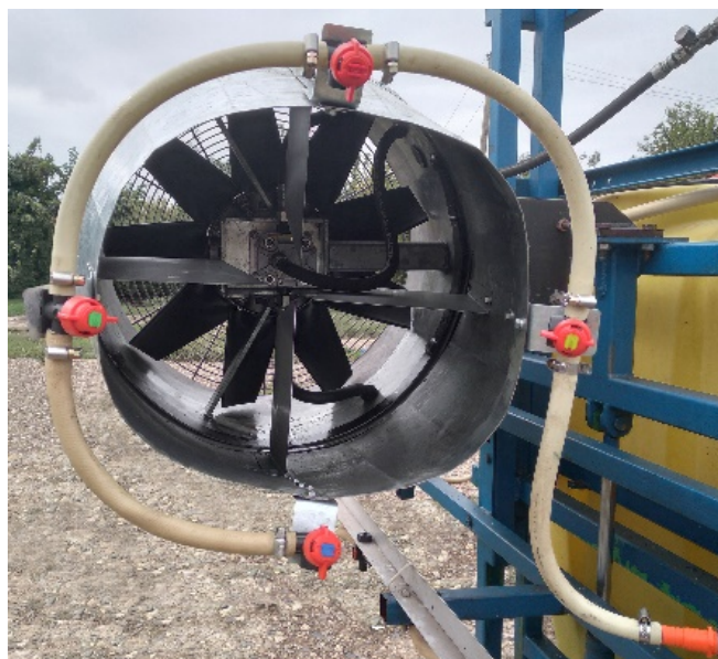
Рисунок 19 – Техническое средство для краевой обработки поля (вид спереди) с установленными четыремя щелевыми распылителями (код цвета – красный, зеленый, желтый и синий)
