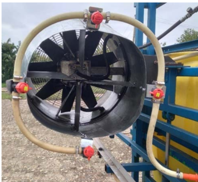
Рисунок 14 – Техническое средство для краевой обработки поля (вид спереди) с крестообразно установленными двумя щелевыми распылителями LU-04. AD-04 (код цвета – красный) и двумя щелевыми распылителями LU-02. AD-02, (код цвета – желтый)
