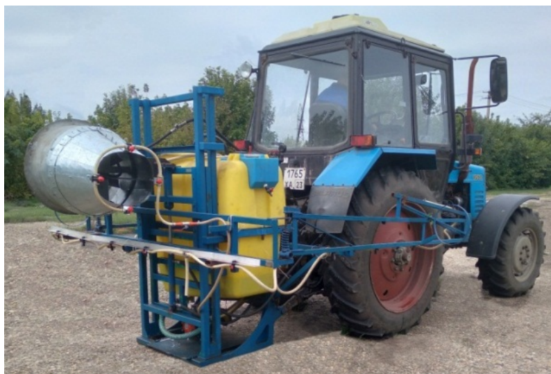
Рисунок 9 – Общий вид технического средства с устройством, оснащенным щелевыми соплами для краевой обработки поля
