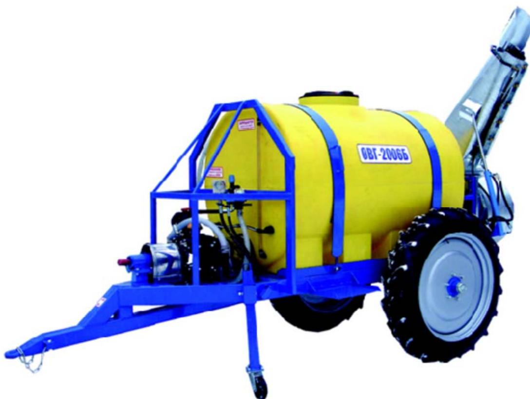
*Рисунок 1 – Полуприцепной тракторный опрыскиватель с вентилятором бокового дутья*
