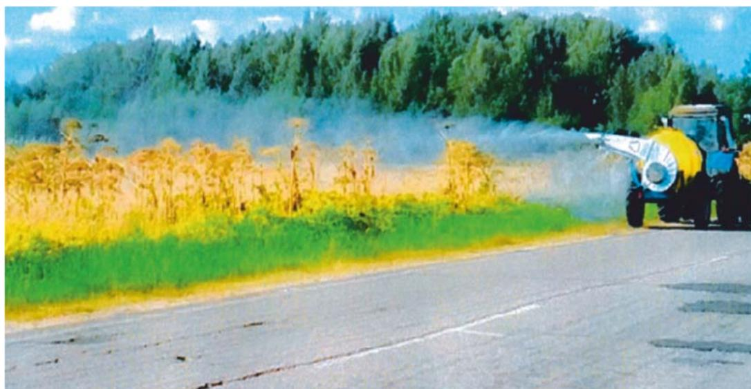
*Рисунок 3 – Полуприцепной тракторный опрыскиватель с вентилятором бокового дутья в работе на обработке растений борщевика*
