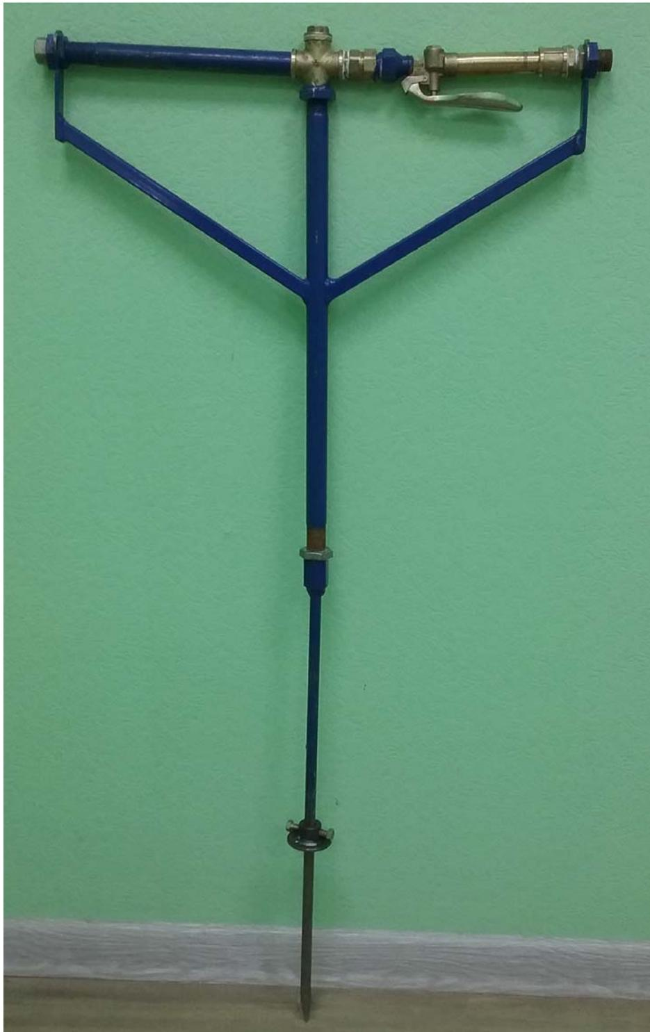
*Рисунок 15 – Общий вид гидробура*
