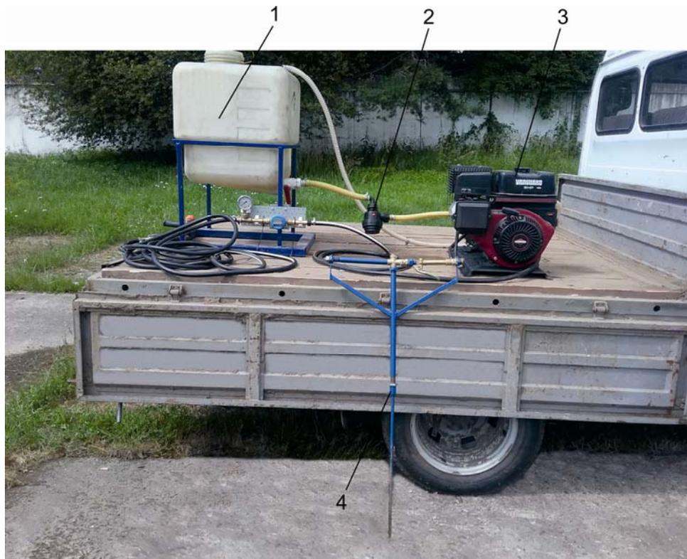
*Рисунок 13 – Общий вид технологического оборудования для внутрипочвенной (корневой) химической обработки растений борщевика:
