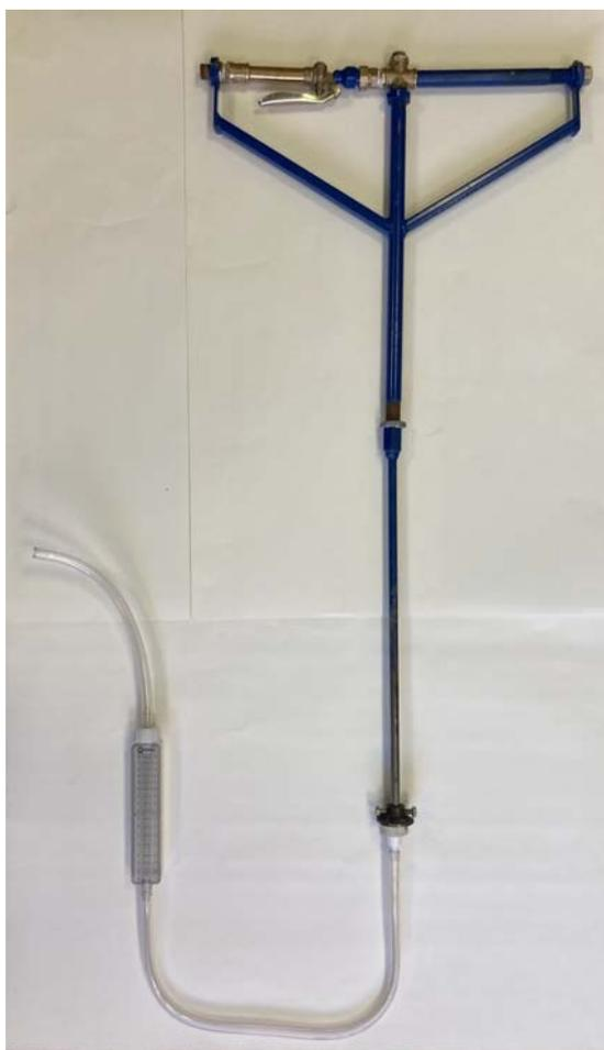
*Рисунок 5 – Гидробур с расходомером фирмы ARAG*
