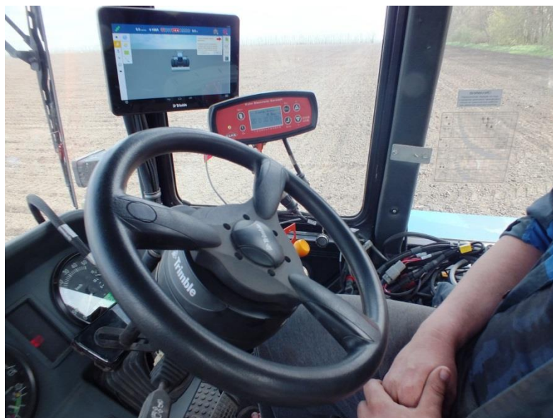
Рисунок 14 – Общий вид системы автоматического вождения Trimble EZ-Pilot+Trimble TMX-2050 в кабине трактора Беларус 1025.2
