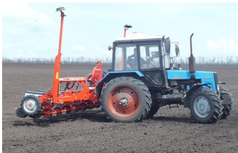
Рисунок 13 – Посевной агрегат Беларусь 1025.2+Kuhn Planter 3, оборудованный системой автоматического вождения Trimble EZ-Pilot+Trimble TМХ-2050
