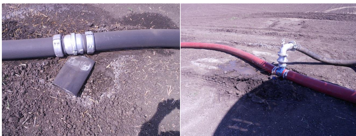
Рисунок 29 – Виды переходников и запорных устройств подающей магистрали
