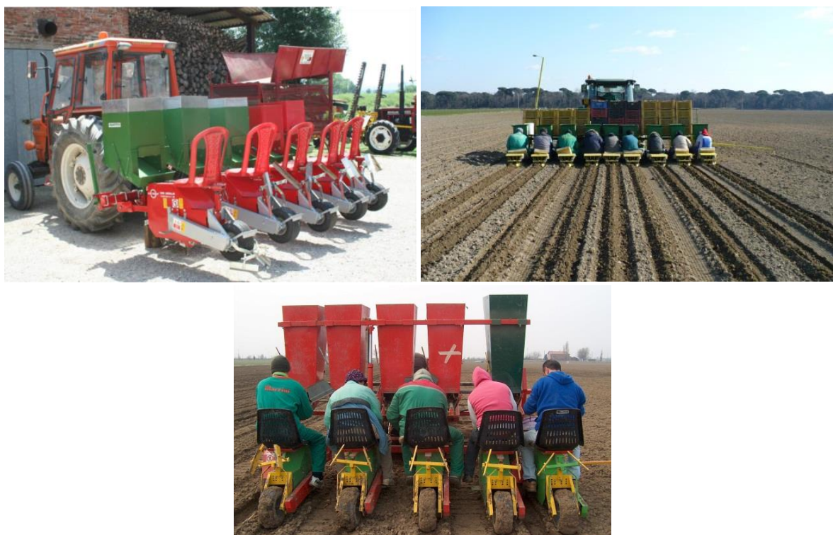
Рисунок 13 – Варианты штеклингопосадочных машин (пяти- и девятирядные)
