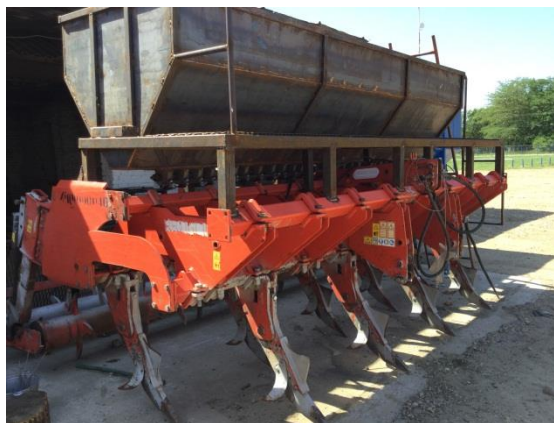
Рисунок 6 – Изготовление бункера для минеральных удобрений на глубокорыхлителе Gaspardo (Италия)
