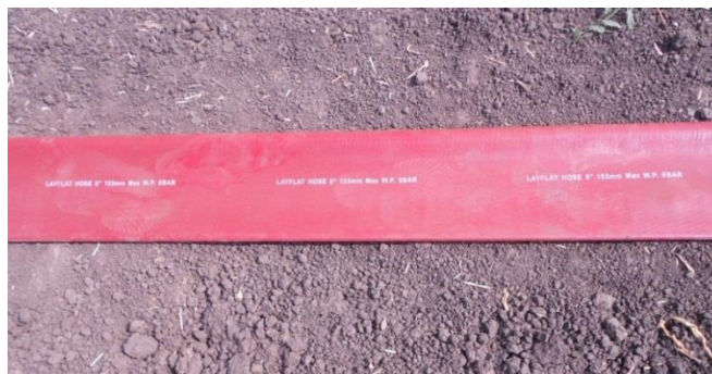
Рисунок 28 – Шланг Layflat Hose перед заполнением водой
