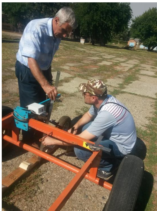
Рисунок 13 – Измерение вертикального расстояния от оси энкодера до пересечения с горизонтальной линией, проходящей через центр измерительного колеса ИП–297
