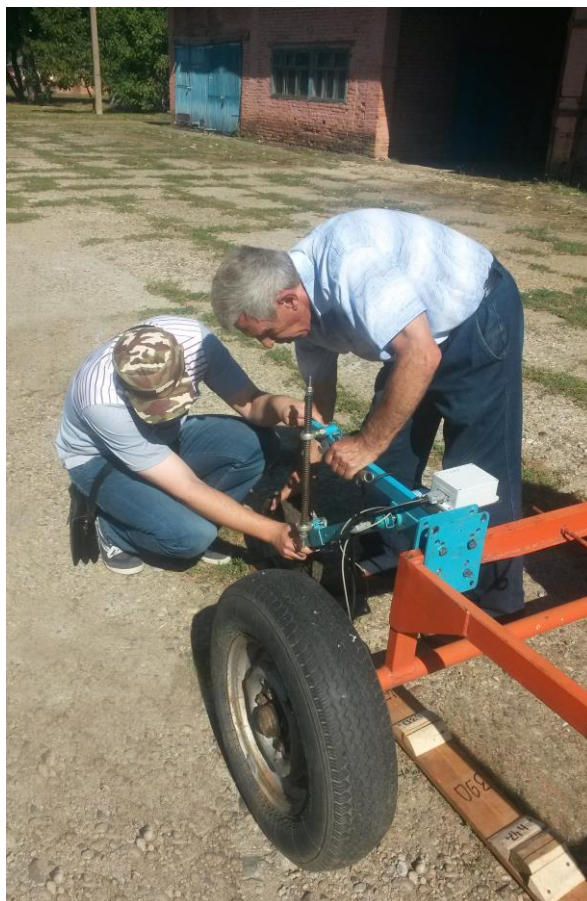
Рисунок 10 – Установка с помощью регулировочных устройств рабочего положения ИП–297 для измерения возвышений на специальной рейке
