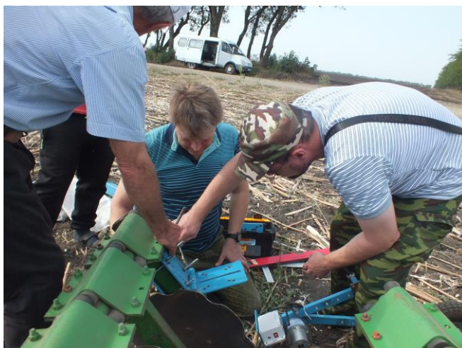
Рисунок 18 – Крепление поворотного устройства к раме КДК-4,5
