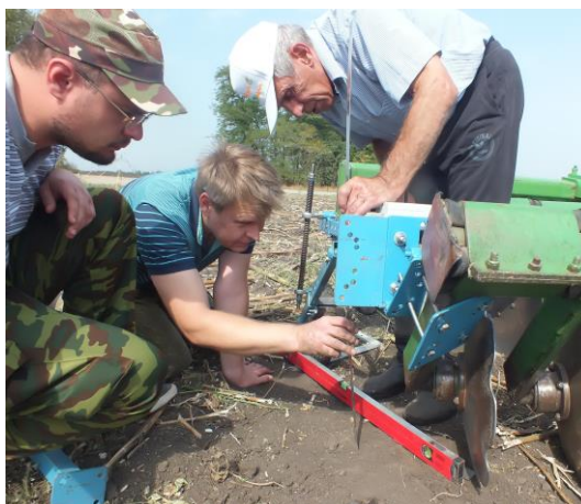
Рисунок 20 – Установка рабочего положения колеса ИП–297 относительно основания диска культиватора дискового комбинированного КДК–4,5 с применением уровня
