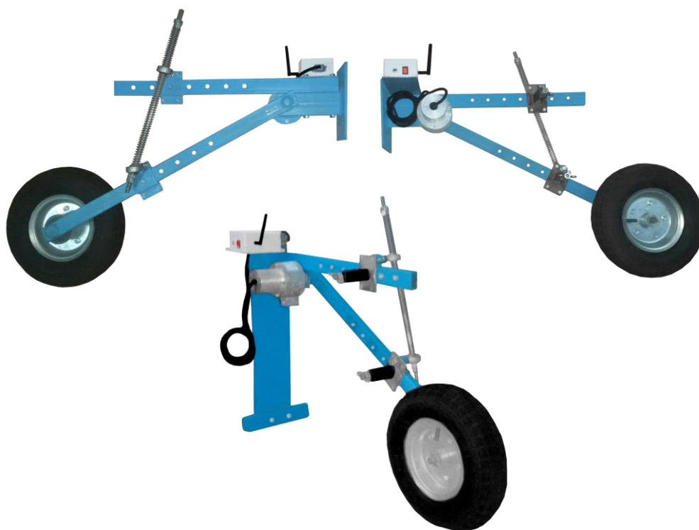
Рисунок 6 – Электронный модуль ИП–296 для приема электрических импульсов от датчика угла поворота подвижного кронштейна технического средства для измерения глубины обработки почвы при определении функциональных показателей почвообрабатывающей техники
