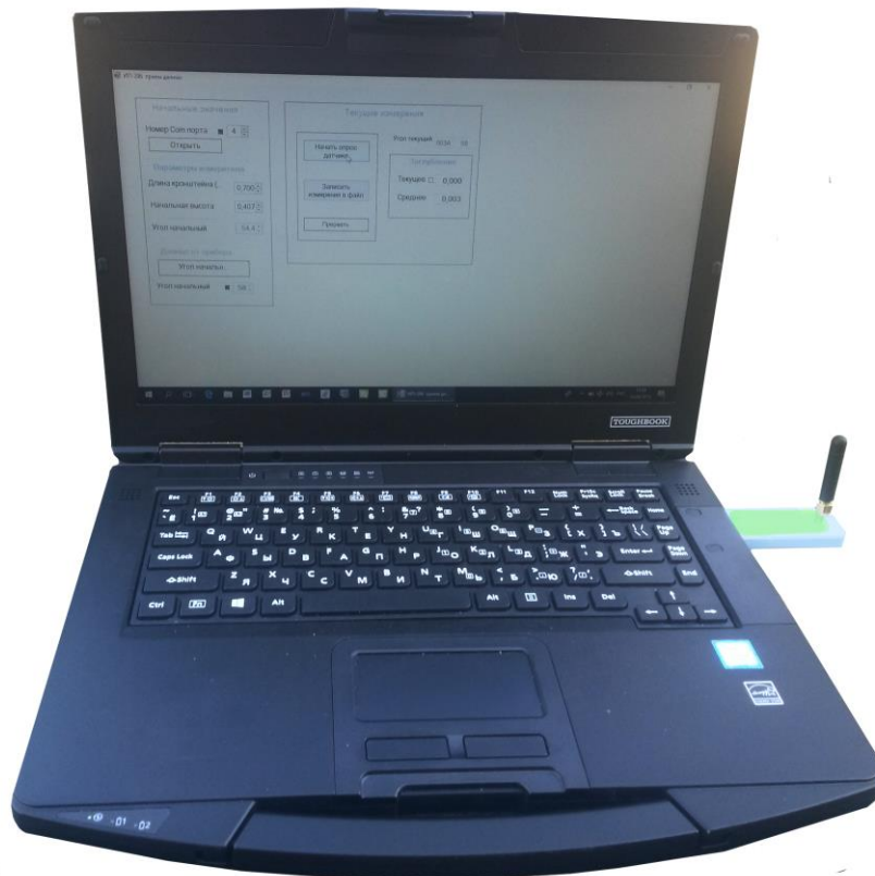
Рисунок 8 – Общий вид ноутбука с программным обеспечением обработки данных, полученных измерительной беспроводной системой в составе технического средства для измерения глубины обработки почвы
