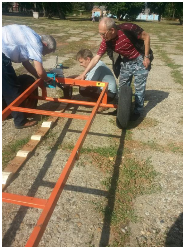
Рисунок 9 – Закрепление ИП–297 на раме подвижного средства для проверки его работоспособности по измерению высот препятствий различного размера
