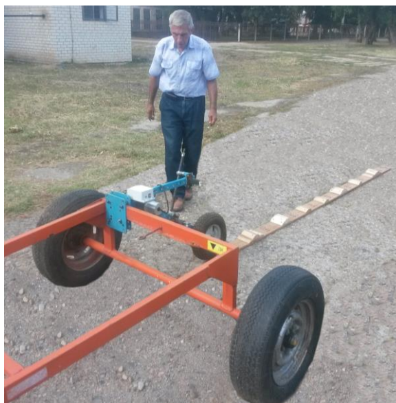
Рисунок 14 – Завершение движение колеса ИП–297 по специальной рейке с препятствиями с фиксированными высотами
