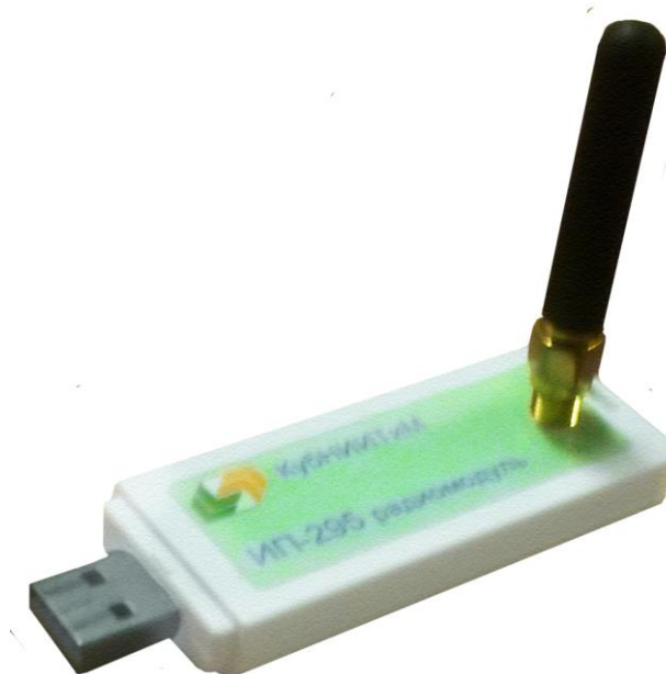
Рисунок Г.1 – Радиомодуль для приема на ЭВМ данных по радиоканалу от блока обработки данных датчика угла поворота
