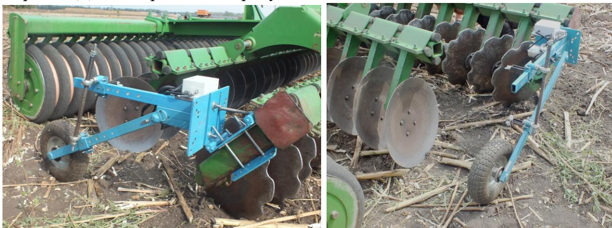
Рисунок 19 – Общий вид ИП-297, закрепленного на раме КДК-4,5
