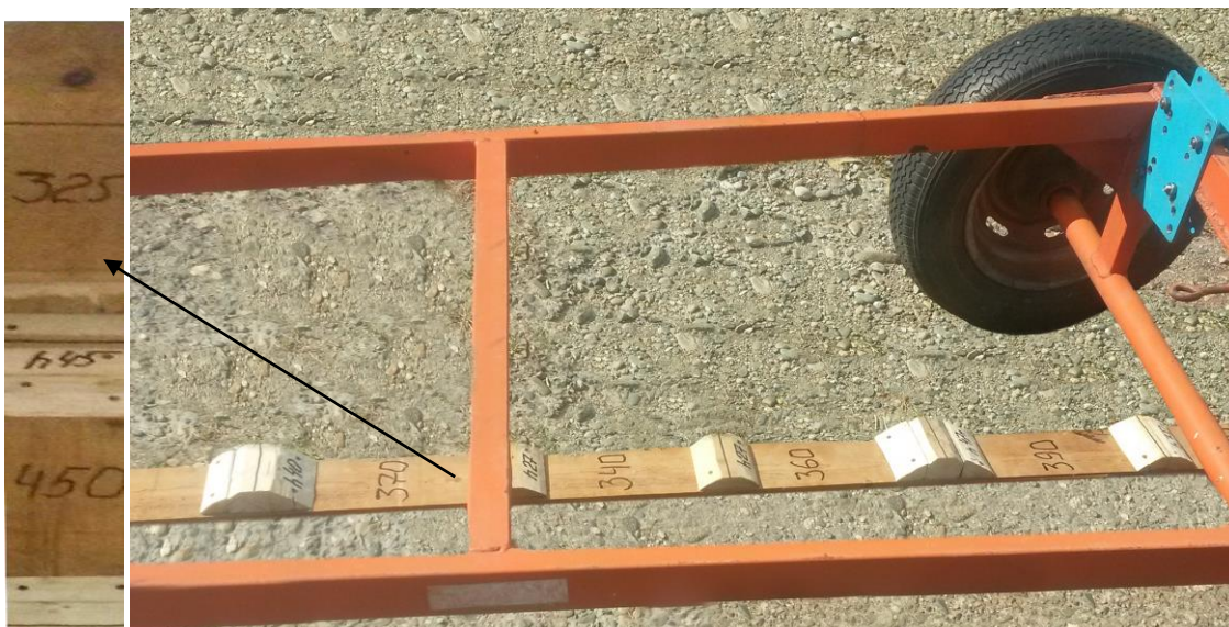
Рисунок 11 – Общий вид препятствий, закрепленных на специальной рейке, установленной на пути передвижения колеса ИП–297
