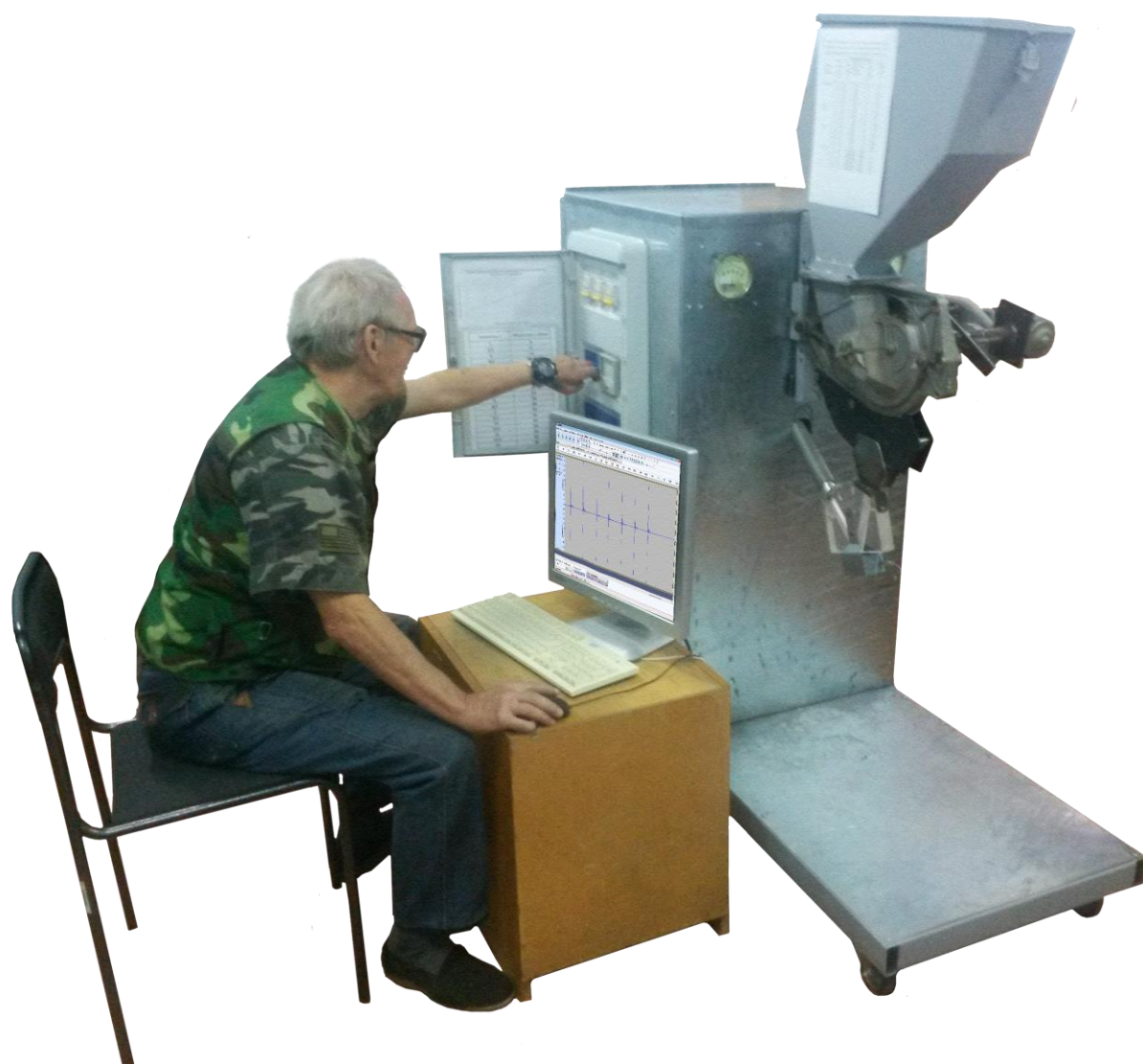
Рисунок 8 – Фрагмент проведения лабораторных исследований работоспособности разработанного стенда ИУ-95 для определения параметров высевающих аппаратов сеялок точного высева
