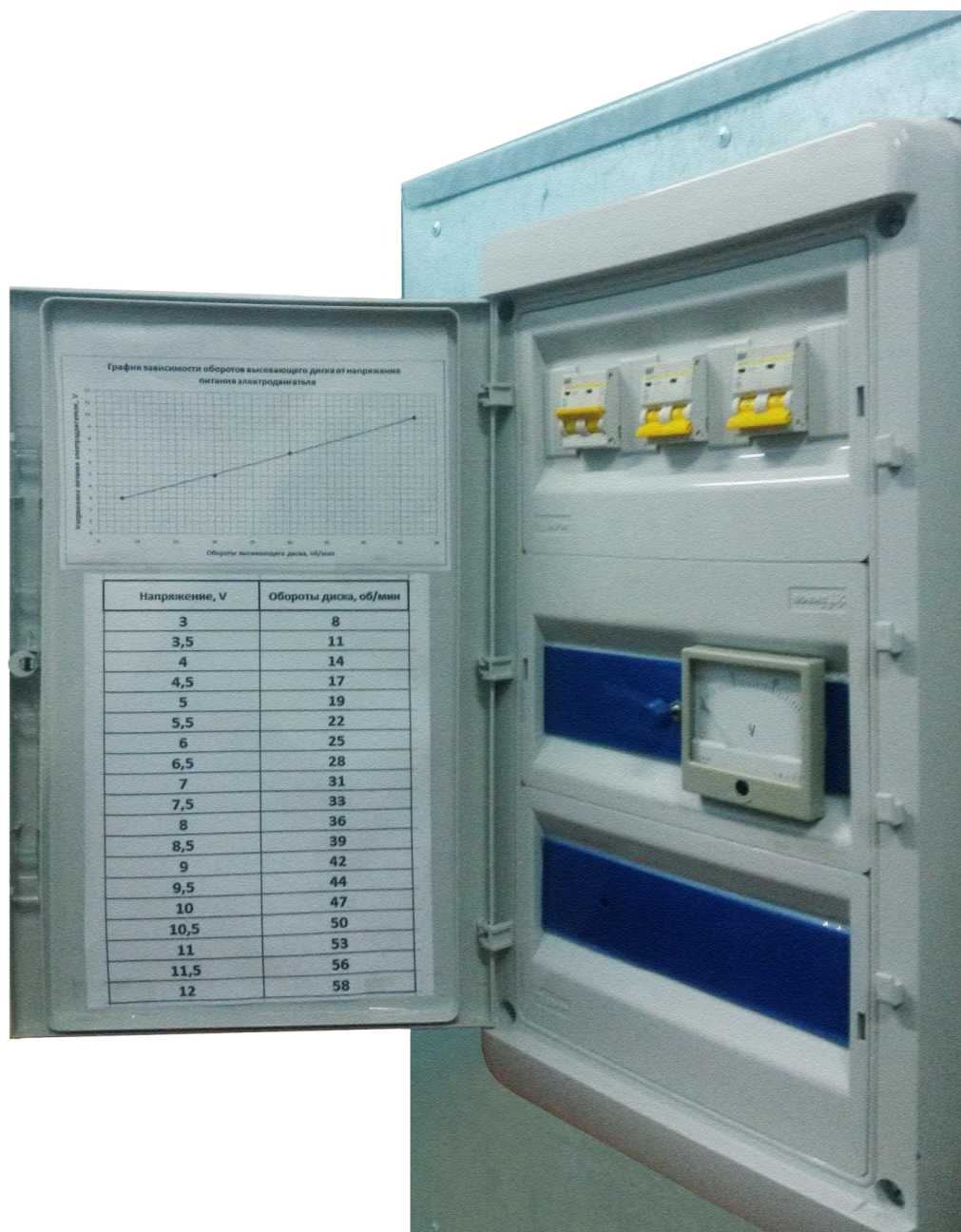
Рисунок 5 – Графические и табличные данные по результатам калибровки оборотов высевающего диска в зависимости от регулируемого напряжения, подаваемого на электродвигатель 12 В М3241, расположенные на внутренней поверхности дверцы электрического щита монтажного с панелью
