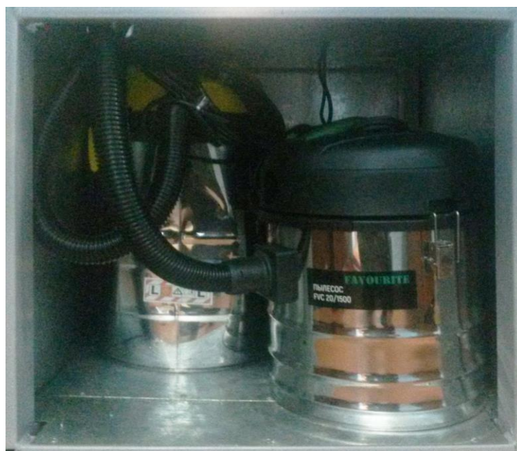
Рисунок 7 – Отсек с расположенными в нем вакуумными насосами
