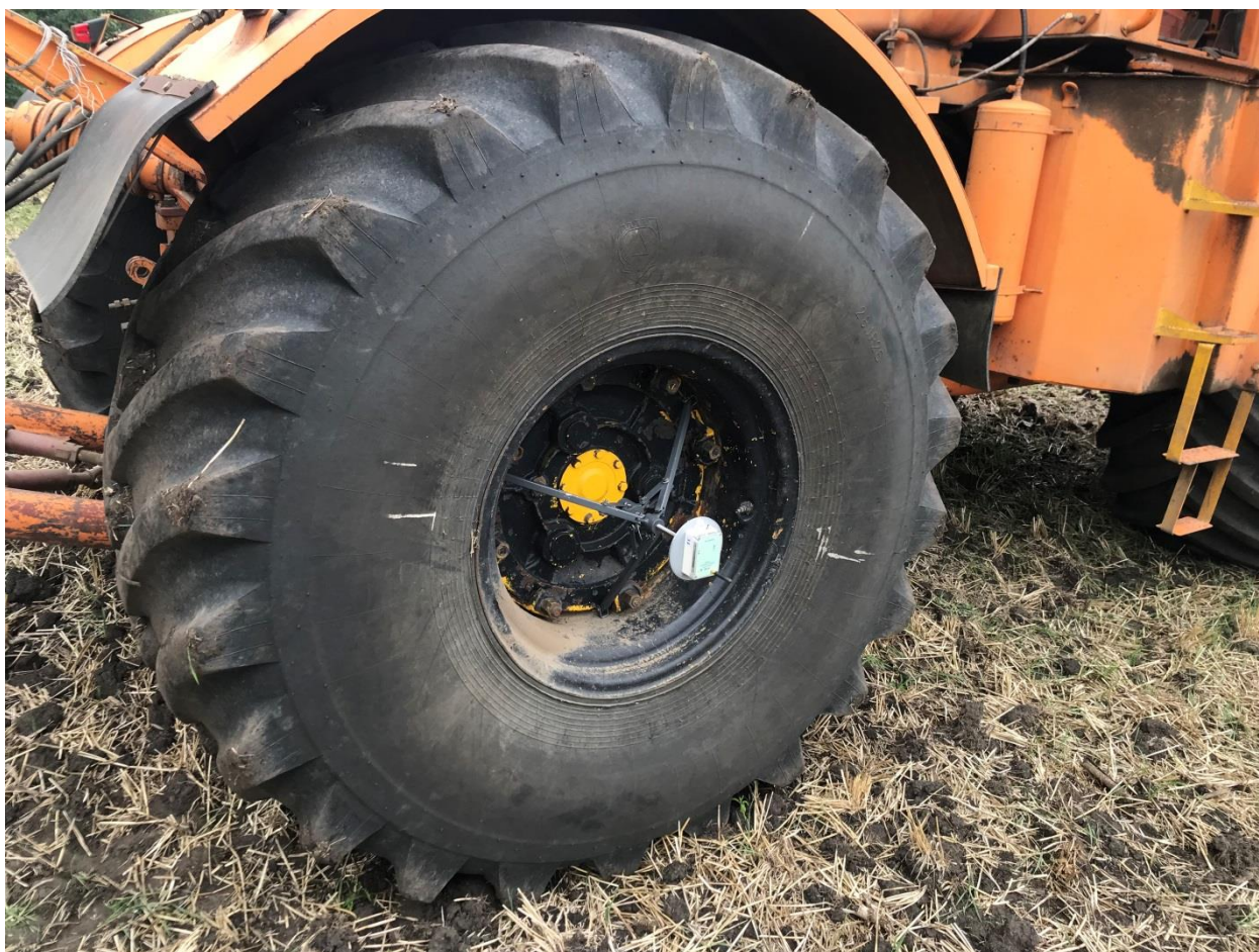
Рисунок 19 – Датчик ИП-291 с адаптером на тракторе К-701
