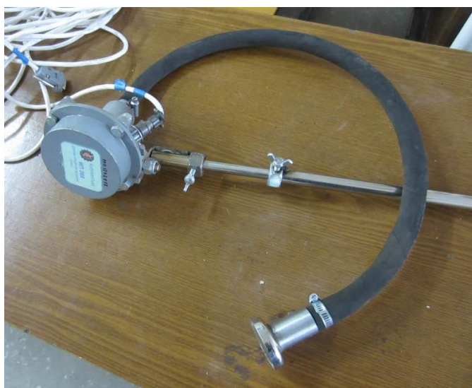
Рисунок 4 – Датчик ИП-268 с муфтой на основе ниодимового магнита
