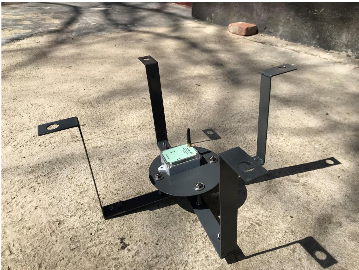
Рисунок 8 – Адаптер для одновременной установки ИП-291 и ИП-268
