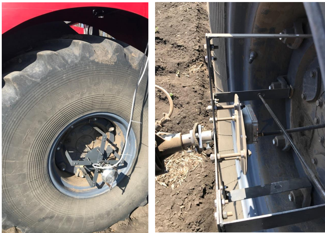
Рисунок 17 – Датчики ИП-291 и ИП-268 на колесе трактора К-744
