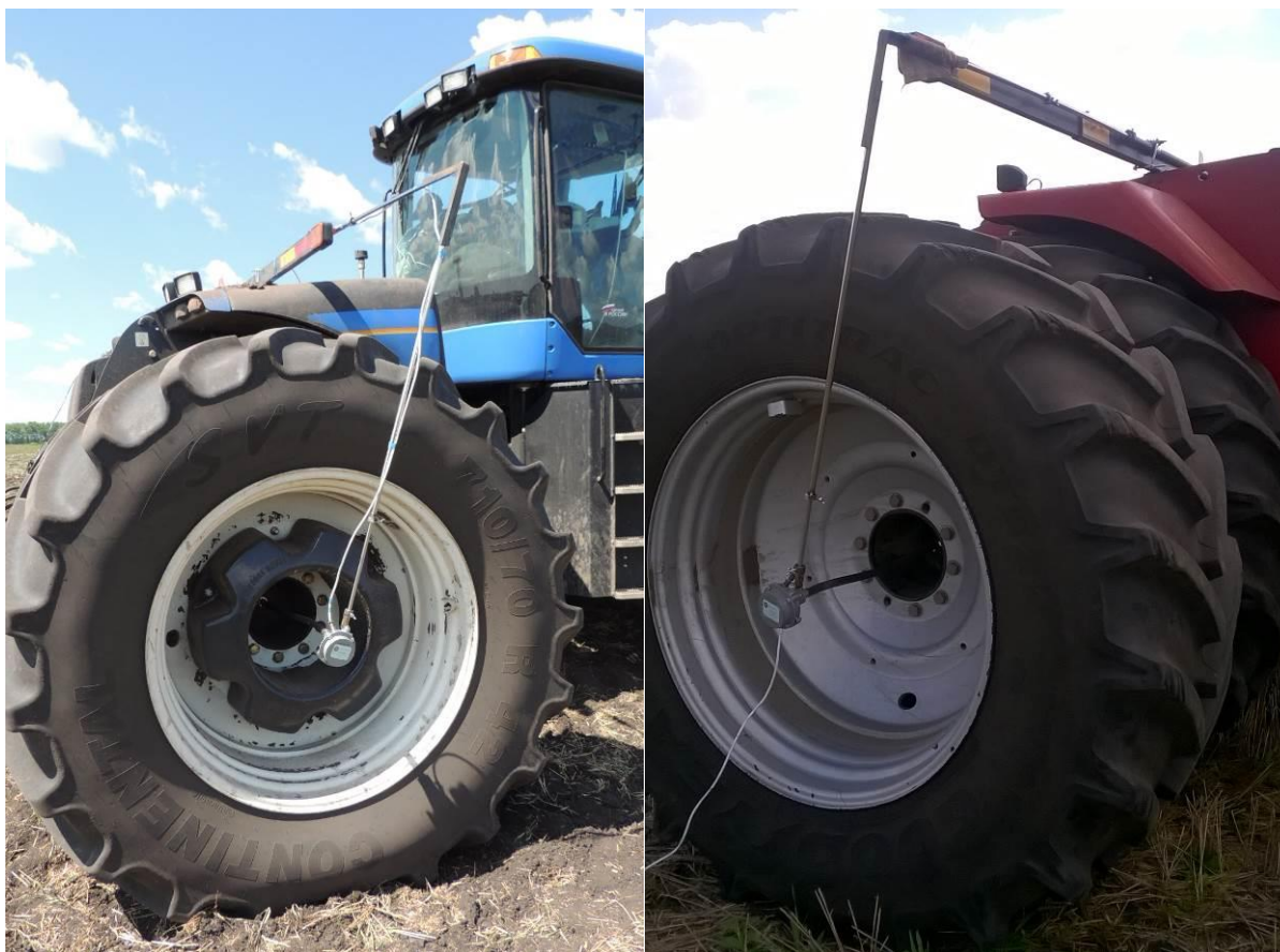
Рисунок 3 – Монтаж датчика ИП-268 на тракторах New Holland t9.505 и Case STX-500
