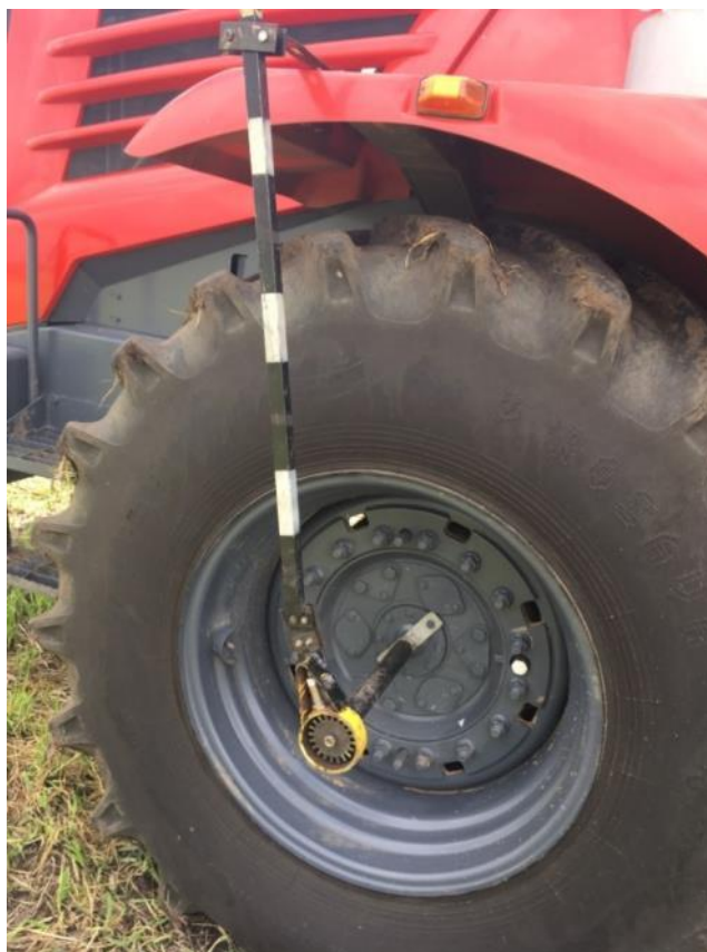
Рисунок 7 – Датчик угла поворота колеса трактора
