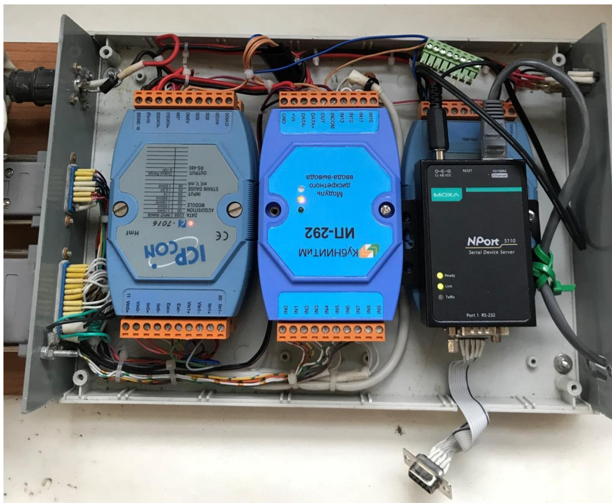
Рисунок 12 – Модуль ИП-292 в измерительной информационной системе ИП-264
