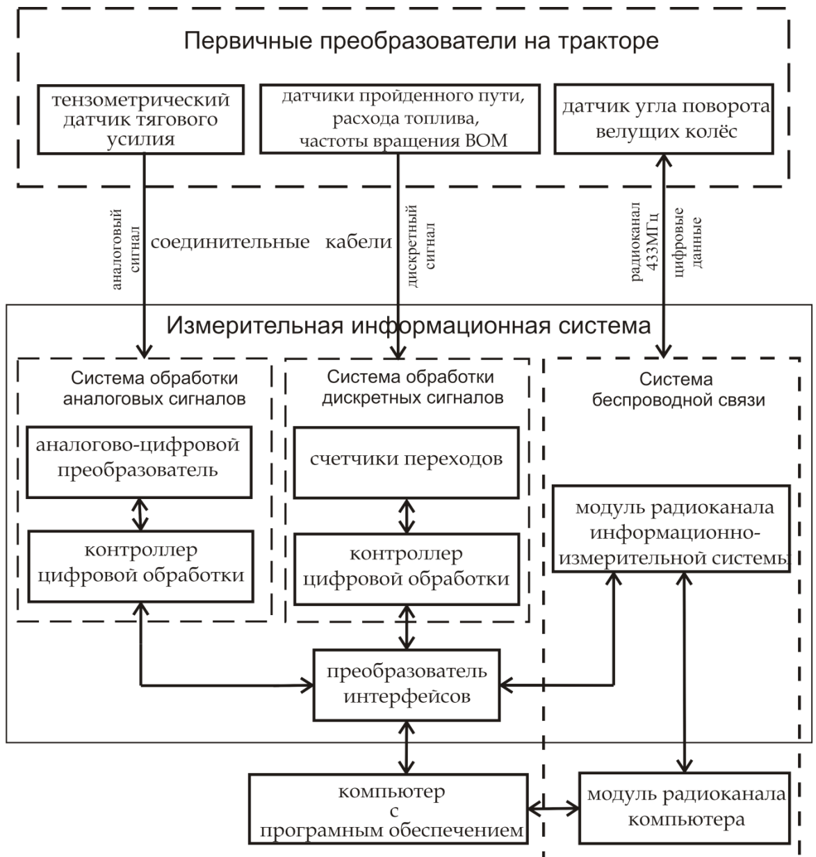
Рисунок 1 – Структурная схема измерительной информационной системы с радиоканалом
