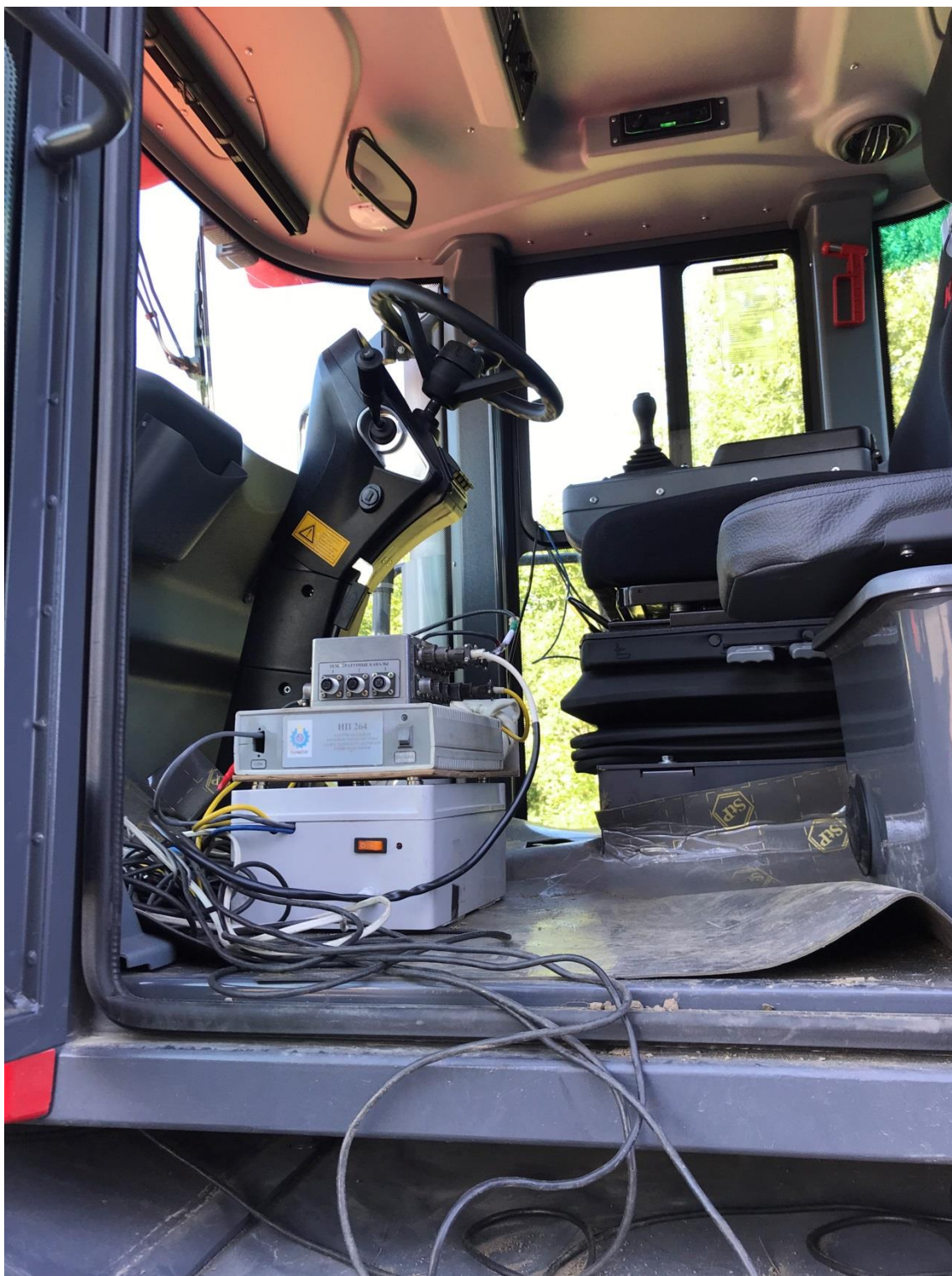
Рисунок 13 – Информационная измерительная система в кабине трактора
