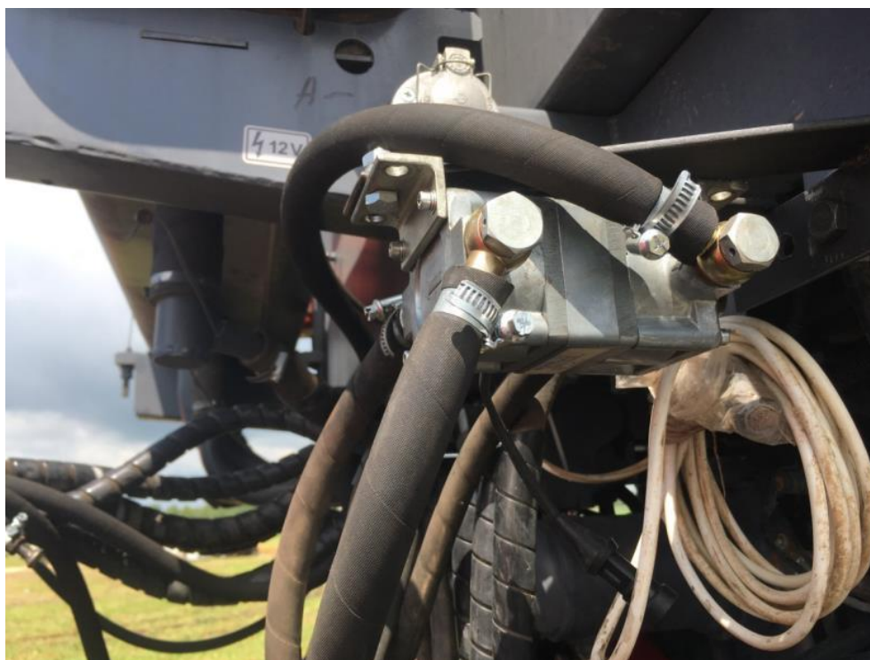
Рисунок 8 – Установленный дифференциальный расходомер топлива
