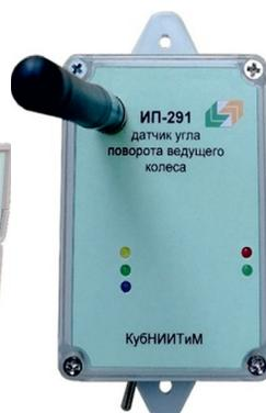
**Рис. 2. Инерциальный датчик буксования ИП-291**
