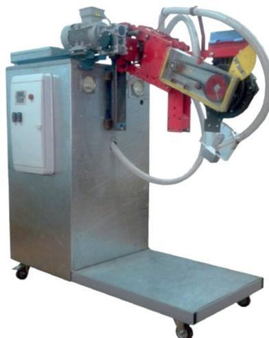
Рис. 6. Стенд для исследования параметров и режимов работы высевальных аппаратов скоростных сеялок точного высева ИУ-97
