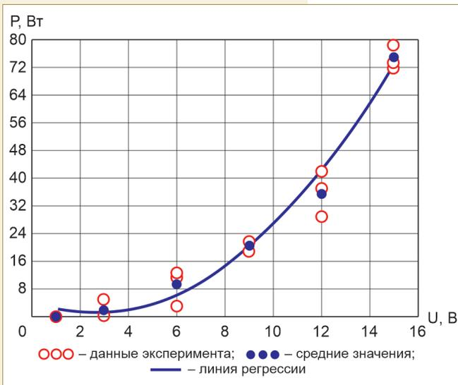
Рис. 5. Зависимость потребляемой мощности  $P$ , Вт, от напряжения питания  $U$ , В
