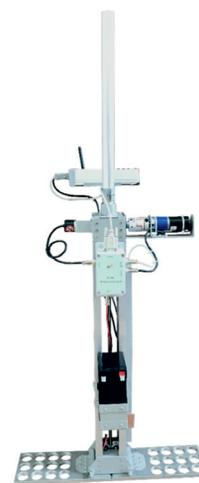
Рис. 7. Твердомер почвы ИП-271
