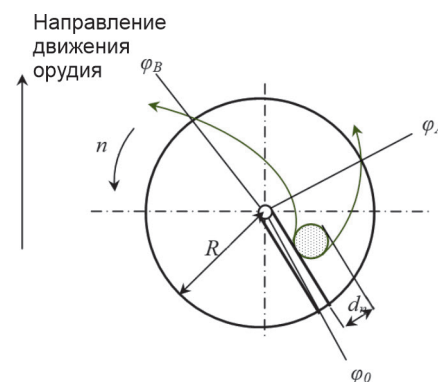
Рис. 2. Расчетная схема разбрасывания устройством гранул удобрений
