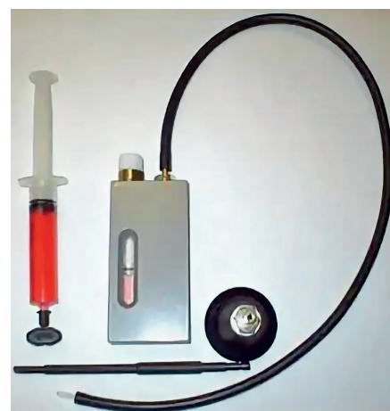
Рис. 3. Приспособление для оценки герметичности впускного тракта ДВС KI-4870 ГОСНИТИ
