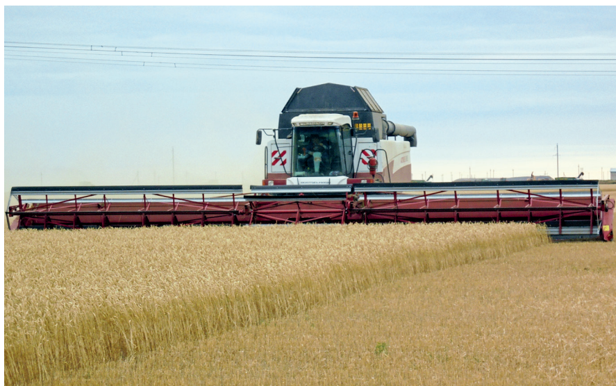
Жатка навесная «Дон Мар ЖН-16» в агрегате с зерноуборочным комбайном 5 класса «Acros-585»
